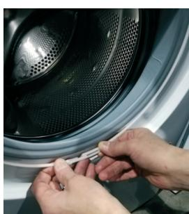
**9** Instalar o vedante na máquina. Inserir o grampo externo e apertá-lo (se necessário, com a pinça)
