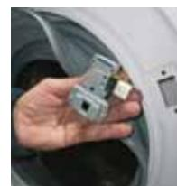
6 | Odklopite ožičenje, v primeru "faston-a" pazite, da ne obrnete ožičenja
