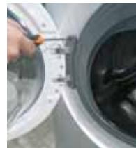
2 | S pomoću cijevnog ključa 25 uklonite vijke koji pričvršćuju šarku na kućište
