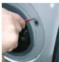
**4** Pomocí klíče Torx vysroubujte upevňovací šrouby zámku dveří a stiskněte jeho přezku.
