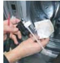
**9** Acil açılma ve elektrik bağlantılarının mekanik bağlarına dikkat ederek kapı kilidini değiştirin
