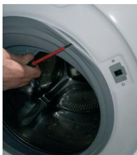
**2** Χρησιμοποιήστε το επίπεδο κατσαβίδιως μοχλό για να αφαιρέσετε τον εξωτερικό σφιγκτήρα
