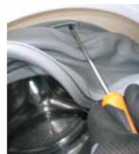
**4** Entfernen Sie mit einem Schlitzschraubendreher die Schelle am Rohr
