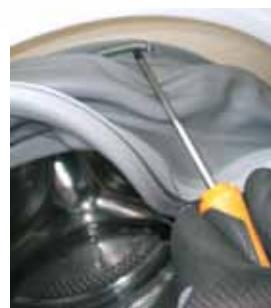
**4** Z uporabo ravnega izvijača odstranite objemko s cevi
