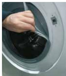
**3** Lösen Sie, nachdem die Klemme entfernt wurde, die Klappe von der Dichtung, um Zugang zum Inneren des Geräts zu erhalten
