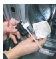
9 | Сменете ключалката на вратата, като внимавате за механичното свързване на аварийното отваряне и електрическите връзки
