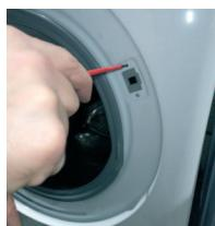
4 Ao utilizar a chave dinamométrica, retirar os parafusos de fixação do trinco da porta e pressionar a sua fivelha.
