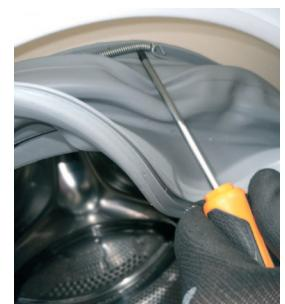
**4** Χρησιμοποιώντας επύπεδο κατσαβίδι, αφαιρέστε τον σφιγκτήρα στον σωλήνα
