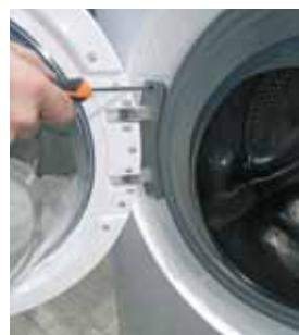
**2** Gebruik de 25 Torx-sleutel om de schroeven te verwijderen waarmee het scharnier aan de kast is bevestigd
