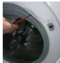
2 | Uporabite ravni izvijač za vzvod in odstranite zunanjobjemko
