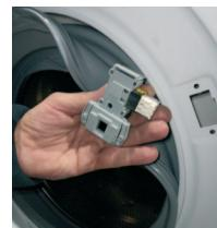
6 Desconecte el cableado, en caso de conexiones "faston", preste atención y no invierta el cableado
