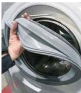
**5** Entfernen Sie die Dichtung
