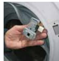
**6** Odspojite ožičenje, u slučaju krimp kontakta, pazite da ne preokrenete ožičenje
