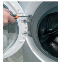
2 | À l'aide de la clé à molette n°25, retirer les vis fixant la charnière au caisson
