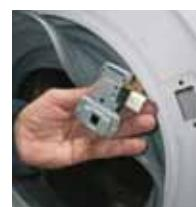
6 Deconectați cablajul, dacă există un „conector”, aveți grijă să nu inversați firele
