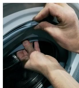
**8** Apriete la abrazadera hasta que quede al ras en el tubo usando las herramientas
