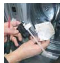
9 Înlocuiți sistemul de închidere a ușii având grijă la conectarea mecanică a deschiderii de urgență și a conexiunilor electrice
