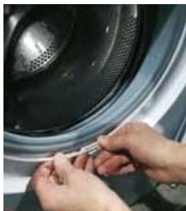
**9** Befestigen Sie die Dichtung am Gehäuse. Bringen Sie die äußere Schelle an und ziehen Sie sie fest (ggf. mit der Zange)
