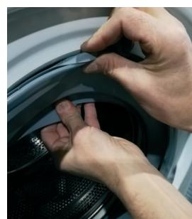
**8** Serrer le collier de serrage au ras du tube en utilisant l'outil
