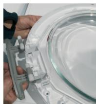
6 | Sostituire la cerniera, facendo attenzione a non perdere le boccole
