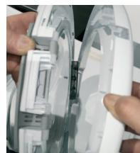
5 Separe el bastidor principal del bastidor secundario
