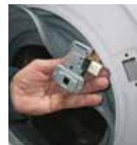
**6** Odspojite ožičenje, a u slučaju „faston“ priključaka, pazite da ne preokrenete ožičenje
