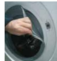
3 Lösen Sie, nachdem die Klemme entfernt wurde, die Klappe von der Dichtung, um Zugang zum Inneren des Geräts zu erhalten
