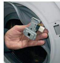
6 Débrancher le câblage ; en cas de « faston », faire attention à ne pas inverser le câblage
