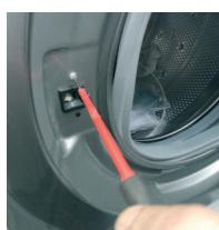
4 En utilisant la clé Torx, retirer les vis de fixation du verrou de la porte.
