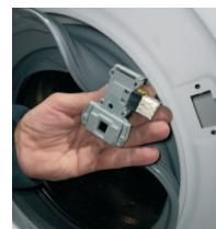
6 Disconnettere il cablaggio; in caso di connettore faston, prestare attenzione a non invertire il cabaggio
