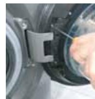
**3** Kada se stezalja ukloni, odvojite poklopac od zaptivke kako biste omogućili pristup unutrašnjosti proizvoda
