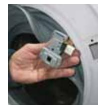
6 | Odłączyć przewody, w przypadku złącz typu „faston” zwrócić uwagę, aby nie odwrócić przewodów
