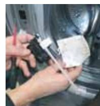
9 | Vymeňte zámok dverí, pričom dajte pozor na mechanické tiahlo núdzového otvárania a elektrické pripojenia
