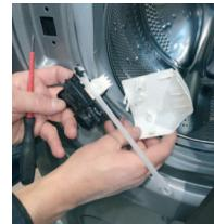
9 Substituir o trinco da porta ao prestar atenção à ligação mecânica de abertura de emergência e ligações elétricas
