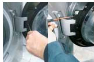
**2** Nehmen Sie die Abdeckung, nachdem Sie deren Schraube entfernt haben, ab
