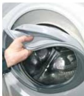
**6** Umístěte nové těsnění, přičemž dejte pozor na polohovací zářezy
