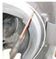
**2** S pomoću ravnog odvijača napravite polugu i uklonite vanjsku kopču
