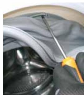
**4** Scoateți clema de pe teavă folosind o șurubelnită cu cap plat
