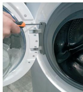
**2** Ao utilizar a chave dinamométrica 25, retirar os parafusos que fixam a dobradiça à máquina
