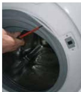
**2** Folosiți șurubelnita cu cap plat pentru a ridica și a scoate clema exterñă
