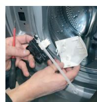
9 Sostituire la chiusura di sicurezza dello sportello facendo attenzione al collegamento meccanico dell'apertura di sicurezza e ai connettori elettrici
