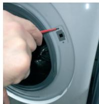
4 En utilisant la clé Torx, retirer les vis de fixation du verrou de la porte, et appuyer sur sa boucle.
