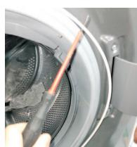
2 Χρησιμοποιήστε το επίπεδο κατσαβίδι ως μοχλό για να αφαιρέσετε τον εξωτερικό σφιγκτήρα
