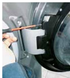
**2** Verwijder het deksel nadat u de schroef hebt verwijderd
