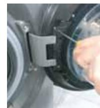
**3** Entfernen Sie die Schrauben des Kunststoffscharniers
