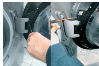
2 Retire la cubierta después de quitar los tornillos
