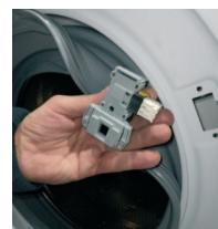
6 Desligar a cablagem; em caso de "faston", prestar atenção para não inverter a cablagem
