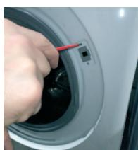
4 Χρησιμοποιώντας μηχανικό κλειδί τύπου Τορχ, αφαιρέστε τις βίδες στερέωσης της ασφάλειας πόρτας και πιέστε την πόρτη.
