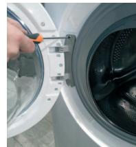
2 | Servendosi del cacciavite T25, rimuovere le viti che tengono fissata la cerniera all'elettrodomestico
