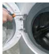
**2** Scoateți șuruburile care fixează balamaua pe dulap cu ajutorul unei chei pentru țevi nr. 25
