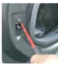
4 | Pomocou kľúča Torx odstráňte upevňovacie skrutky zámku dverí
