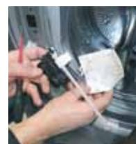
9 | Zamenjajte zapiralo vrat tako, da pazite na mehansko povezavo zasilnega odpiranja in električno povezavo
