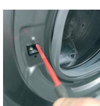
4 Utilizzare il cacciavite Torx per rimuovere le viti che tengono fissata la chiusura di sicurezza dello sportello
