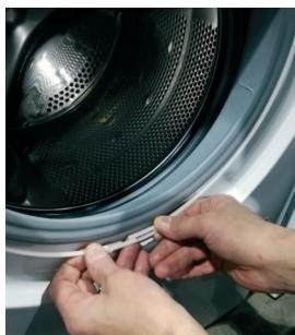
**9** Fixer le joint sur le caisson. Fixer le collier de serrage externe et le serrer (si nécessaire avec une pince)
