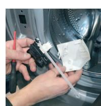
9 Vuelva a colocar el seguro de la puerta prestando atencion a la conexión mecánica de la apertura de emergencia y las conexiones eléctricas
