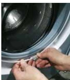
**9** Postavite brtvu na kućište. Pričvrstite vanjsku kopču i zategnite je (po potrebi hvataljkom)
