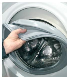
**6** Placer le nouveau joint, en faisant attention aux encoches de positionnement
