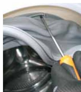
**4** S pomoću ravnog odvijača uklonite kopču sa cijevi
