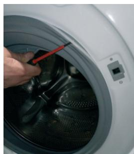
**2** Use el destornillador plano como palanca y retire la abrazadera externa
