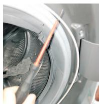
2 Utilizar a chave de fendas de cabeça plana para pressionar e retirar o grampo externo
