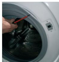
2 Use el destornillador plano como palanca y retire la abrazadera externa
