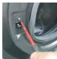
4 Entfernen Sie mit dem Torx-Schlüssel die Befestigungsschrauben des Türschlusses
