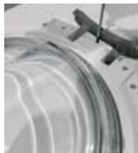
**4** Entfernen Sie alle Schrauben an der Tür
