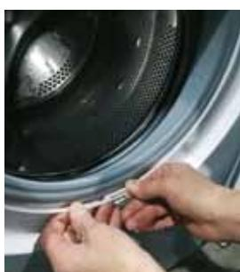
**9** Montați garnitura pe dulap. Fixați clema exterñă și strângeți-o (la nevoie, folosiți cleștele)
