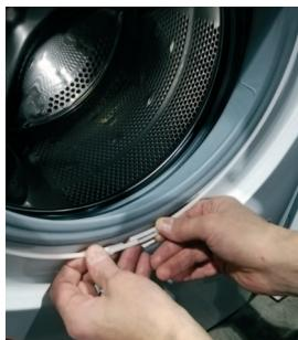
**9** Posizionare la guarnizione sull'elettrodomestico. Fissare la fascetta esterna e stringerla (se necessario aiutarsi con la pinza)
