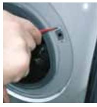
4 | Pomocou kľúča Torx vyskrutkujte upevňovacie skrutky zámku dverí a stlačte jeho pracku.
