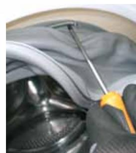
**4** | Pomocou plochého skrutkovača odstráňte svorku na trubici
