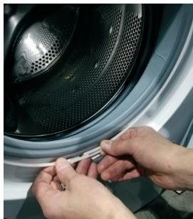
**9** Coloque el empaque en el gabinete. Sujete la abrazadera externa y apriétela (de ser necesario con la pinza)
