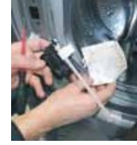
9 Ersetzen Sie das Türschloss. Achten Sie dabei auf die mechanische Verbindung der Notöffnung und die elektrischen Anschlüsse
