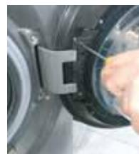
**3** Scoateți șuruburile balamalei din plastic
