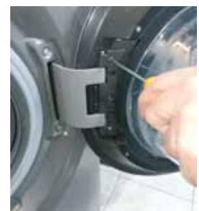
**3** Verwijder de schroeven van het plastic scharnier
