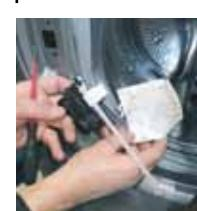
9 Vervang het deurslot en let op de mechanische koppeling van de noodeopening en elektrische aansluitingen
