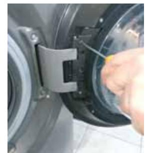
**3** Entfernen Sie die Schrauben des Kunststoffschwingers
