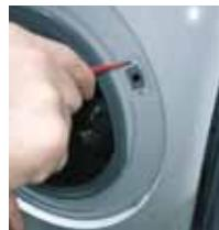
4 Entfernen Sie mit dem Torx-Schlüssel die Befestigungsschrauben des Türschlusses, und drücken Sie auf dessen Schnalle.
