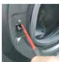
4 Scoateți șuruburile care fixează încuietoarea ușii cu ajutorul unei chei torx
