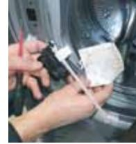
**9** Vyměňte zámek dveří, přičemž dejte pozor na mechanické táhlo nouzového otevírání a elektrická připojení
