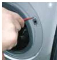
4 | S torx ključem odstranite pritrdilne vijke na zapiralu vrat in pritisnite na njegovo zaponko.
