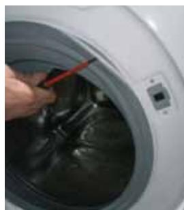
**2** Gebruik de platte schroevendraaier voor hefboomwerking en verwijder de externe klem
