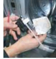
**9** Zamenite bravu vrata, obraćajući pažnju na mehaničku vezu otvaranja u hitnim slučajevima i električnu vezu
