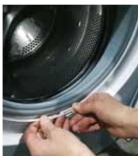
**9** Nasadte těsnění na skříň. Upevněte vnější svorku a utáhněte ji (v případě potřeby s kleštěmi)
