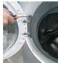
2 | Pomocí trubkového klíče 25 vyšroubujte šrouby, které připevňují závěs ke skříni
