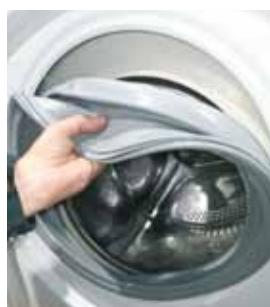
**6** Postavite novu zaptivku, obraćajući pažnju na ureze za pozicioniranje
