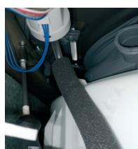
9 | Rimuovere le viti all'interno dell'elettrodomestico con la chiave a tubo 7. Rimuovere la cerniera
