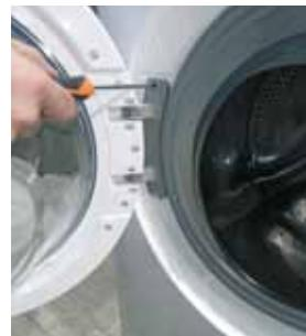
**2** Entfernen Sie mit dem 25er Torx-Schlüssel die Schrauben, mit denen das Scharnier am Gehäuse befestigt ist
