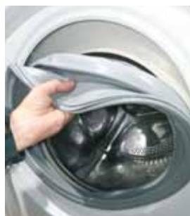
**6** Setzen Sie die neue Dichtung ein. Achten Sie dabei auf die Positionierungskerben
