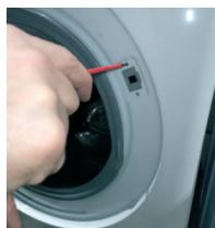
4 Utilizzare il cacciavite Torx per rimuovere le viti che tengono fissata la chiusura di sicurezza dello sportello e premere sul suo fermo.
