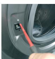
4 Χρησιμοποιώντας μηχανικό κλειδί τύπου Τορχ, αφαιρέστε τις βίδες στερέωσης της ασφάλειας πόρτας
