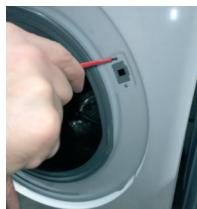
4 Con la llave Torx retire los tornillos de sujeción del seguro de la puerta y presione el broche.
