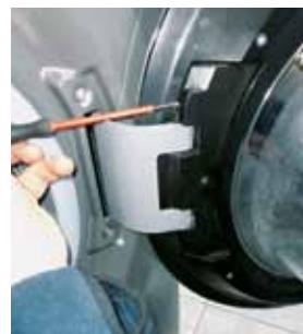
**2** Nehmen Sie die Abdeckung, nachdem Sie deren Schraube entfernt haben, ab
