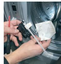
9 Remplacer le verrou de la porte en faisant attention à la liaison mécanique de l'ouverture d'urgence et aux connexions électriques
