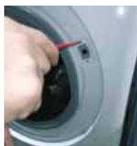
4 Gebruik een Torx-sleutel, verwijder de bevestigingsschroeven van het deurslot en druk op de sluiting.
