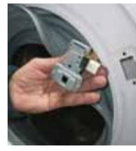
6 | V prípade „upevnenie“ odpojte kabeláž, dávajte pozor, aby ste kabeláž neobrátili
