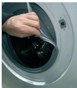
**3** Despues de quitar la abrazadera, desprenda la cubierta del empaque a fin de permitir el acceso al interior del producto
