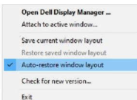
Pour revenir à une disposition préférée, choisissez d'abord « **Save current window layout (Sauvegarder la disposition)** » puis « **Restore saved window layout (Restaurer la disposition de fenêtre enregistrée)** ».
