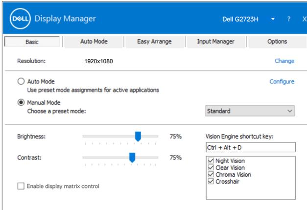
**REMARQUE :** Lorsque plusieurs moniteurs Dell sont connectés, sélectionnez "Activer le contrôle de la matrice d'affichage" pour appliquer les contrôles prédéfinis de luminosité, contraste et couleur à tous les moniteurs.
