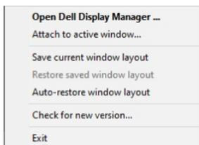
Si vous choisissez « **Restauration automatique de la disposition des fenêtres** », les positions des fenêtres de vos applications sont suivies et mémorisées par Dell Display Manager. Dell Display Manager met automatiquement les fenêtres des applications à leurs positions d'origine lorsque vous reconnectez votre ordinateur au(x) moniteur(s).
