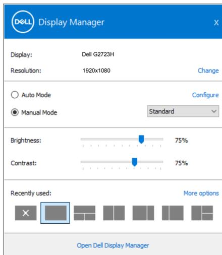
La boîte de dialogue **Réglages rapides** permet également d'accéder à l'interface utilisateur avancée de Dell Display Manager qui sert à régler les fonctions de base, configurer le mode automatique et accéder à d'autres fonctions.
