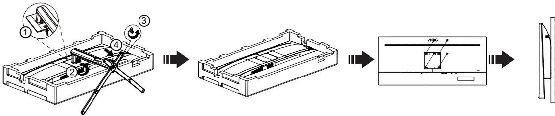
Dieser Monitor kann an einen Wandhängearm, den Sie separat kaufen können, angebracht werden. Trennen Sie bitte vor der Installation die Stromversorgung. Folgen Sie dann den Schritten unten:
