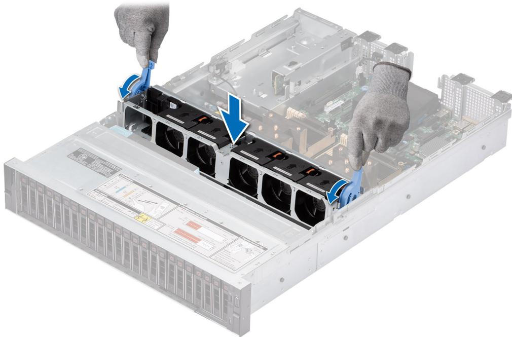
**Ilustración 30. Instalación del compartimento del ventilador de refrigeración**
