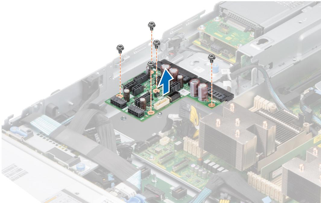
**Ilustración 124. Extracción de la placa mediadora de alimentación**
