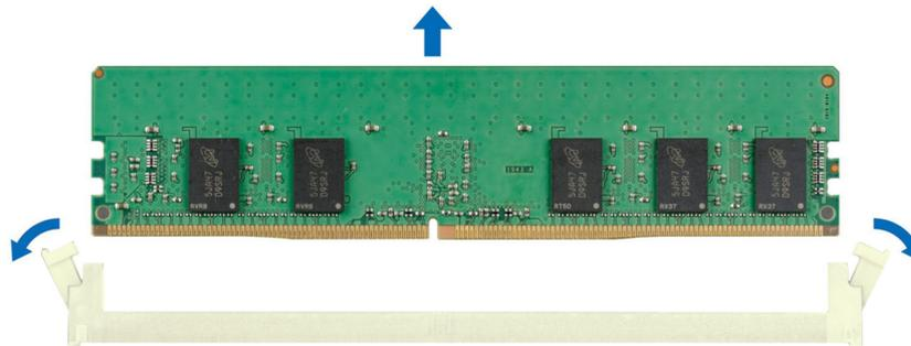
**Ilustración 63. Extracción de un módulo de memoria**
