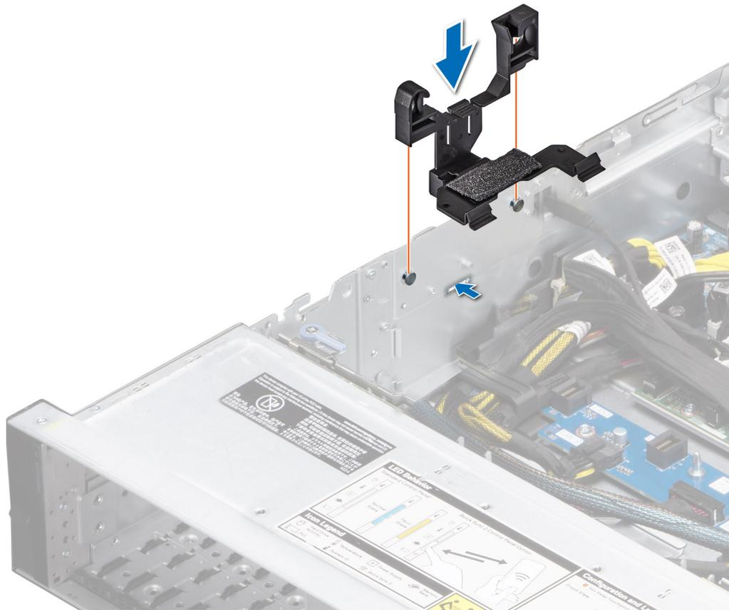
**Ilustración 34. Instalación del soporte de pared lateral**
