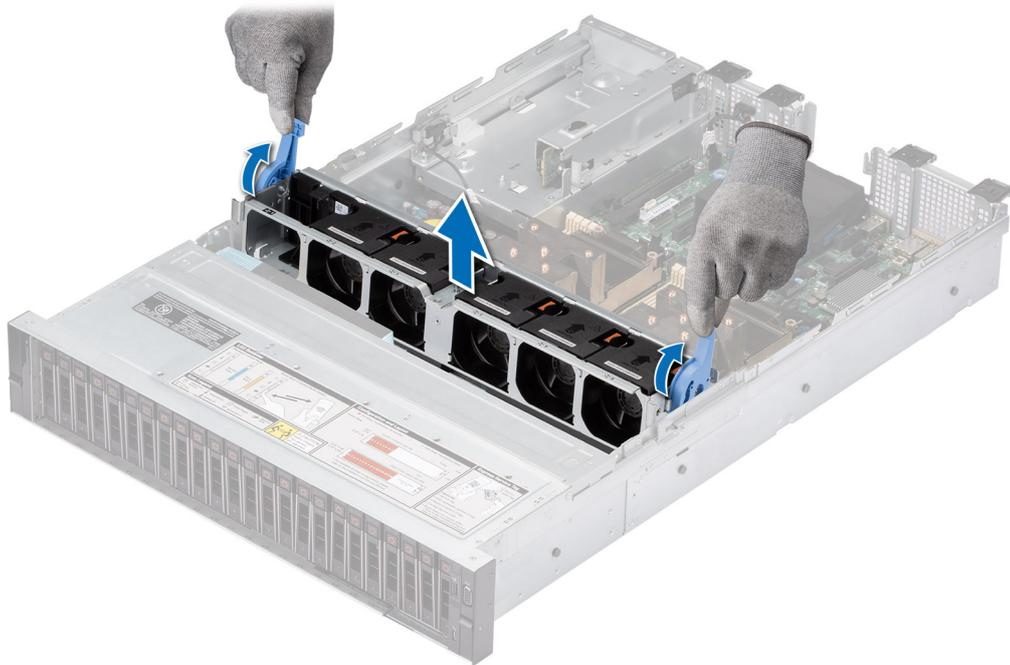
**Ilustración 29. Extracción del compartimento del ventilador de refrigeración**
