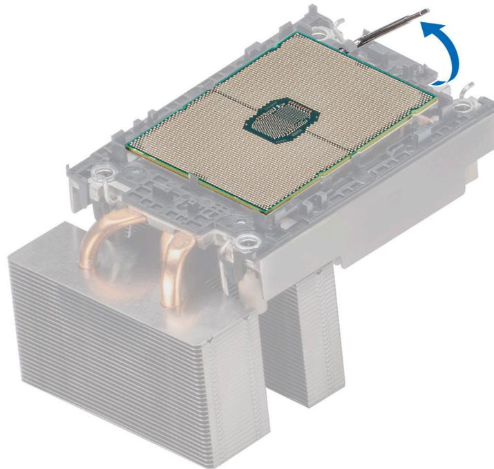
**Ilustración 67.** Levante la palanca de liberación del TIM
