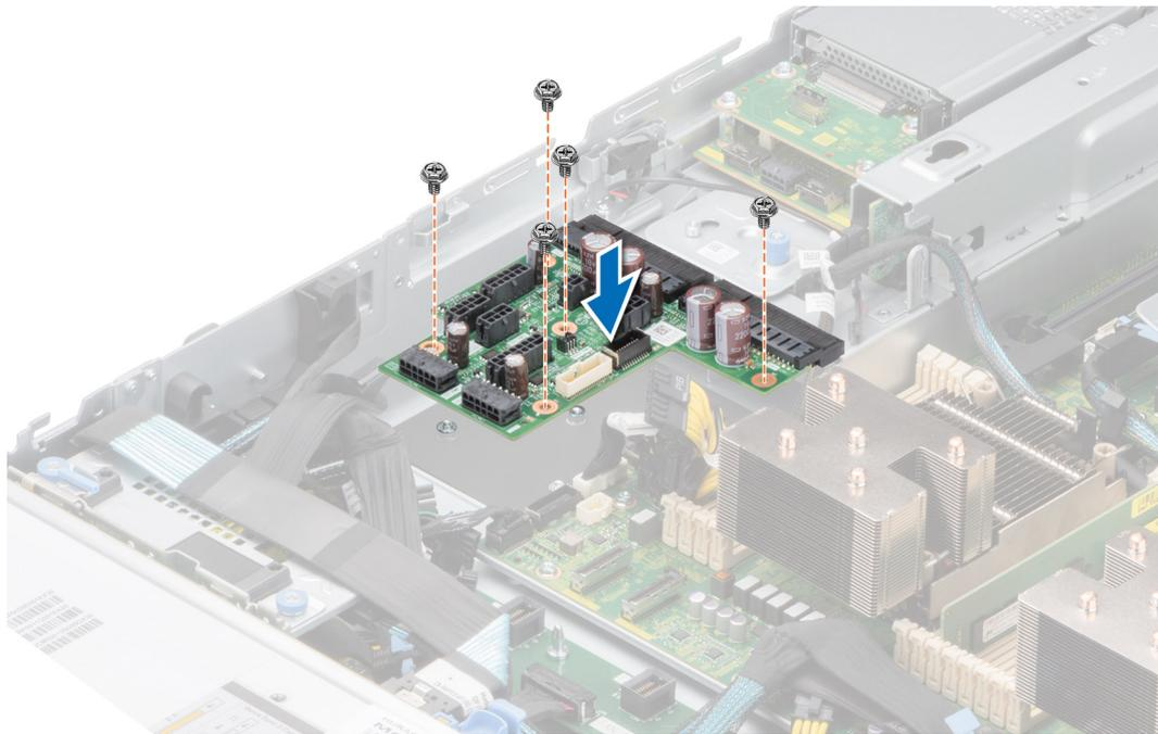
**Ilustración 125. Instalación de la placa mediadora de alimentación**
