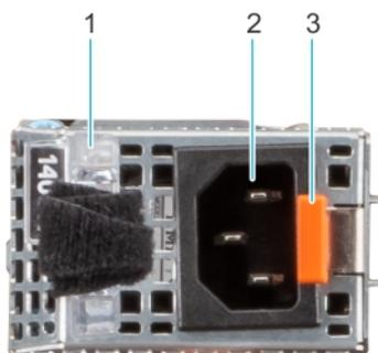
**Ilustración 138. Indicador de estado de PSU de CA**
