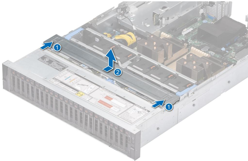
**Ilustración 21. Extracción de la cubierta del backplane de la unidad**
