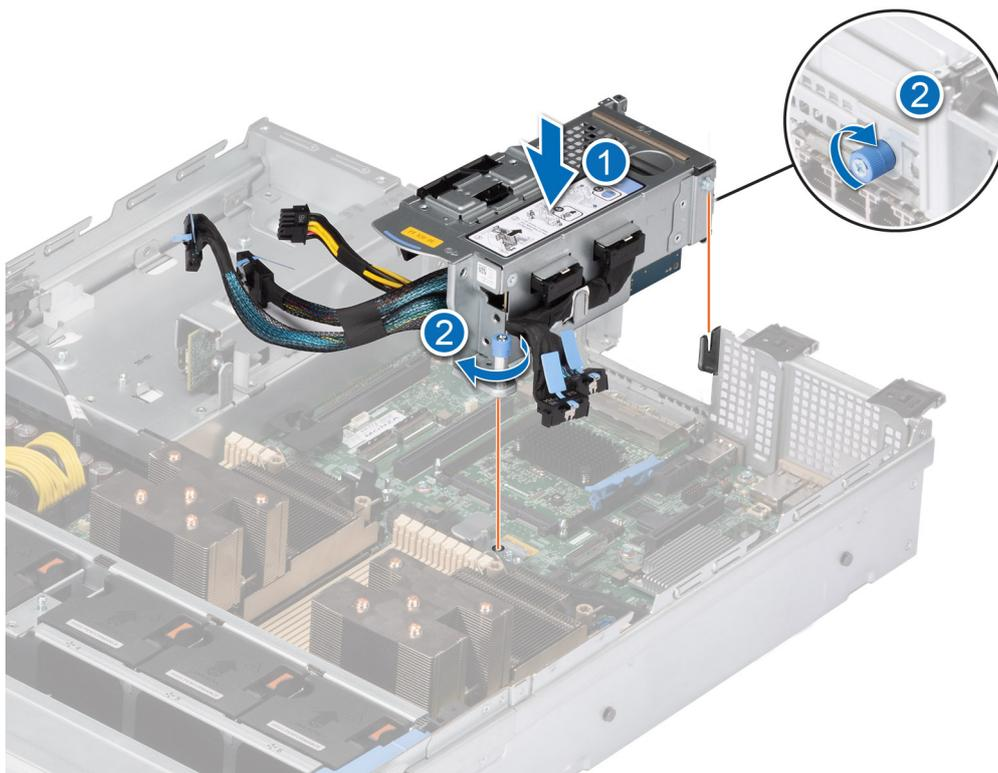
**Ilustración 82. Instalación del soporte vertical cableado 1A**
