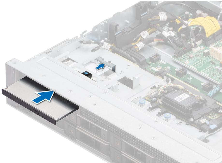
**Ilustración 24. Instalación de la unidad de disco óptico**
