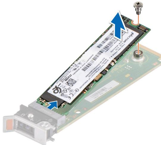
**Ilustración 95. Extracción de la SSD M.2**
