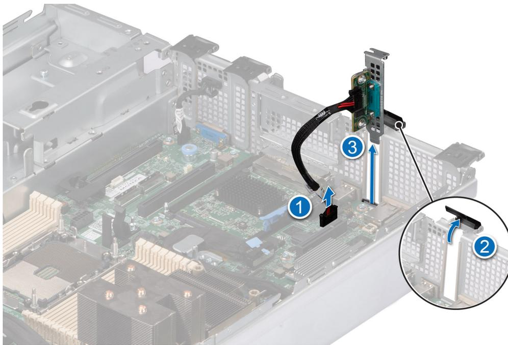
**Ilustración 37. Extracción del puerto serial de COM**
