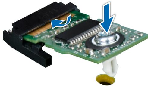
Ilustración 128. Instalación del TPM
