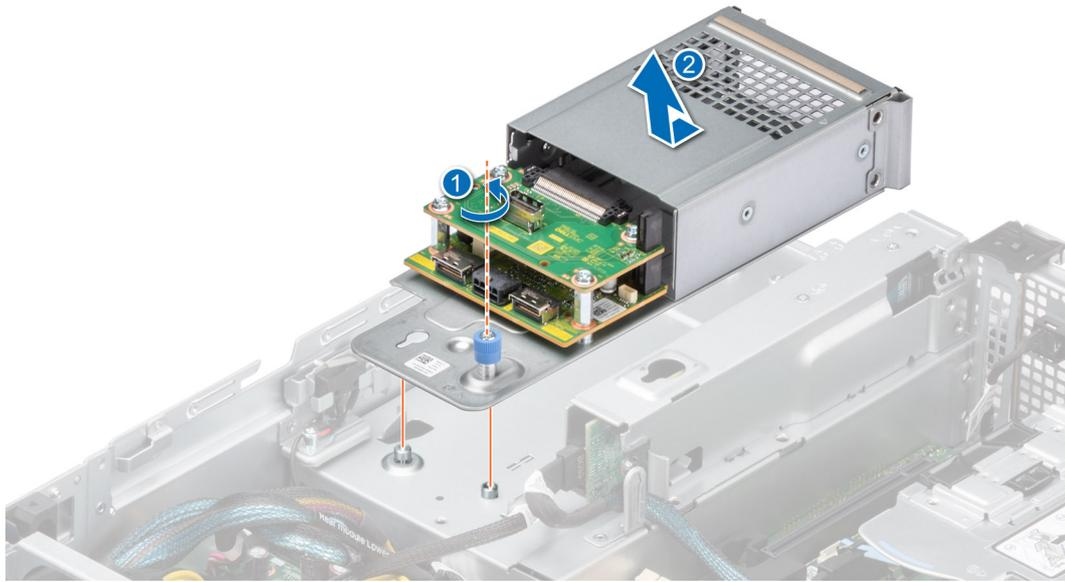
**Ilustración 110. Extracción del módulo de unidad posterior**
