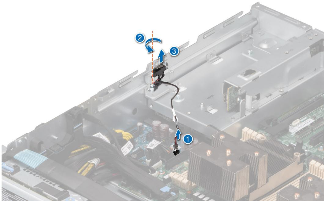
**Ilustración 35. Extracción del módulo del interruptor de intrusiones**
