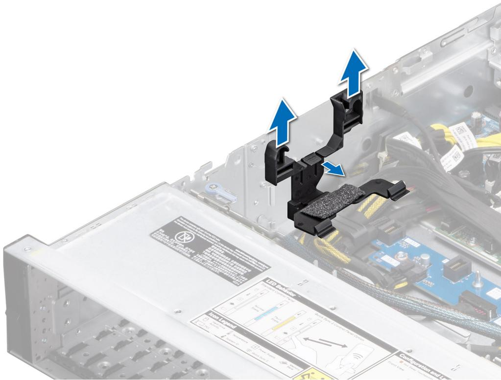
**Ilustración 33. Extracción del soporte de pared lateral**
