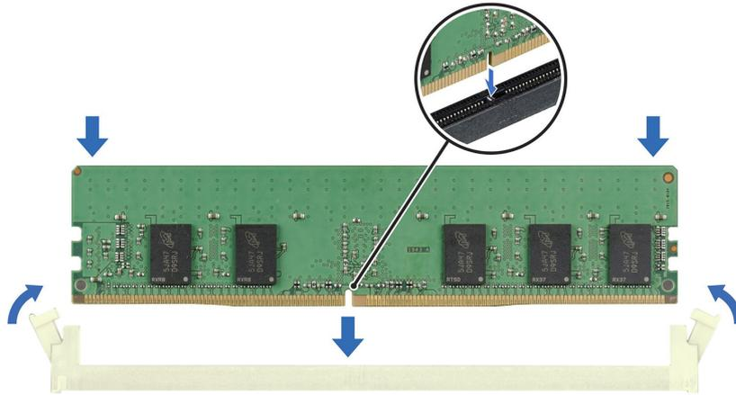
**Ilustración 64. Instalación de un módulo de memoria**
