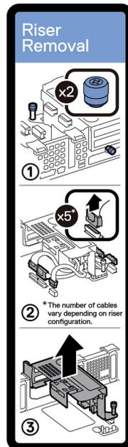
Ilustración 15. Extracción del soporte vertical
