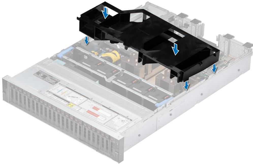
**Ilustración 26. Instalación de la cubierta para flujo de aire**
