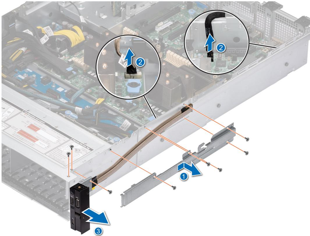
**Ilustración 131. Extracción del panel de control derecho**
