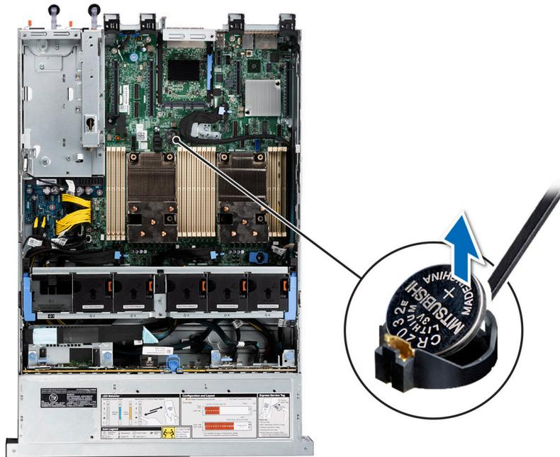
Ilustración 116. Extracción de la batería del sistema
