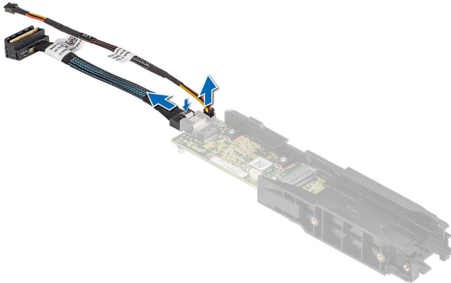
**Ilustración 97. Extracción del cable de alimentación de Boot Optimized Storage Subsystem y el cable de señal de Boot Optimized Storage Subsystem del módulo de la tarjeta controladora de Boot Optimized Storage Subsystem S2**
