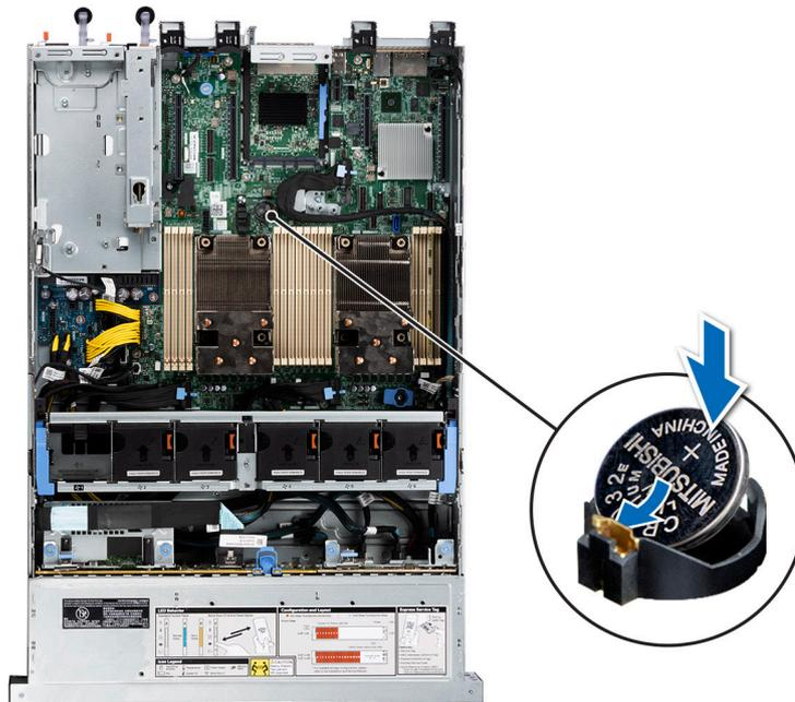
Ilustración 117. Instalación de la batería del sistema
