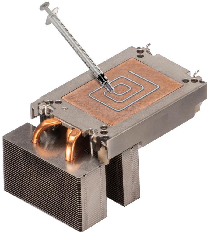
**Ilustración 72. Aplicación de la grasa térmica**
