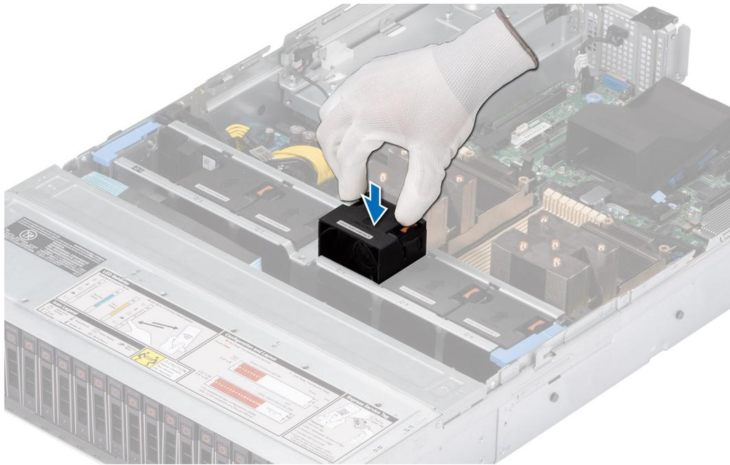
**Ilustración 28. Instalación de un ventilador de refrigeración**
