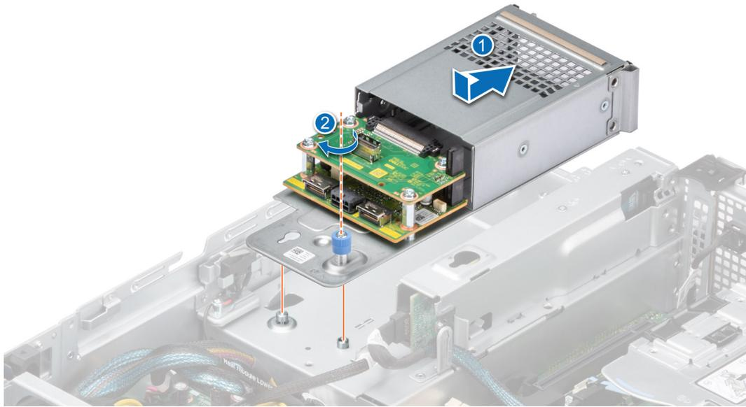
**Ilustración 111. Instalación del módulo de unidad posterior**
