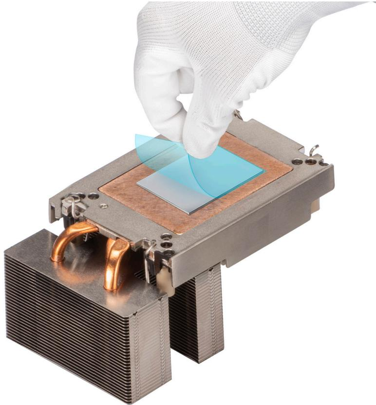
**Ilustración 73. Extraiga la película de protección del material de interfaz térmica (TIM)**
