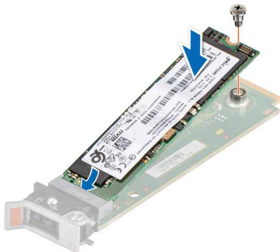
**Ilustración 101. Instalación de la SSD M.2**
