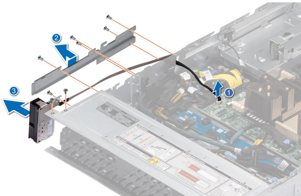
**Ilustración 129. Extracción del panel de control izquierdo**
