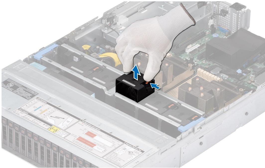
**Ilustración 27. Extracción de un ventilador de refrigeración**
