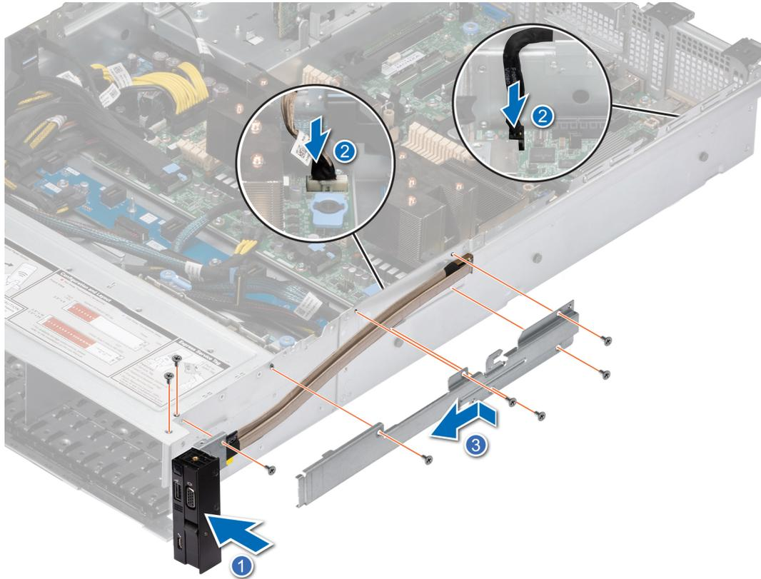
**Ilustración 132. Instalación del panel de control derecho**
