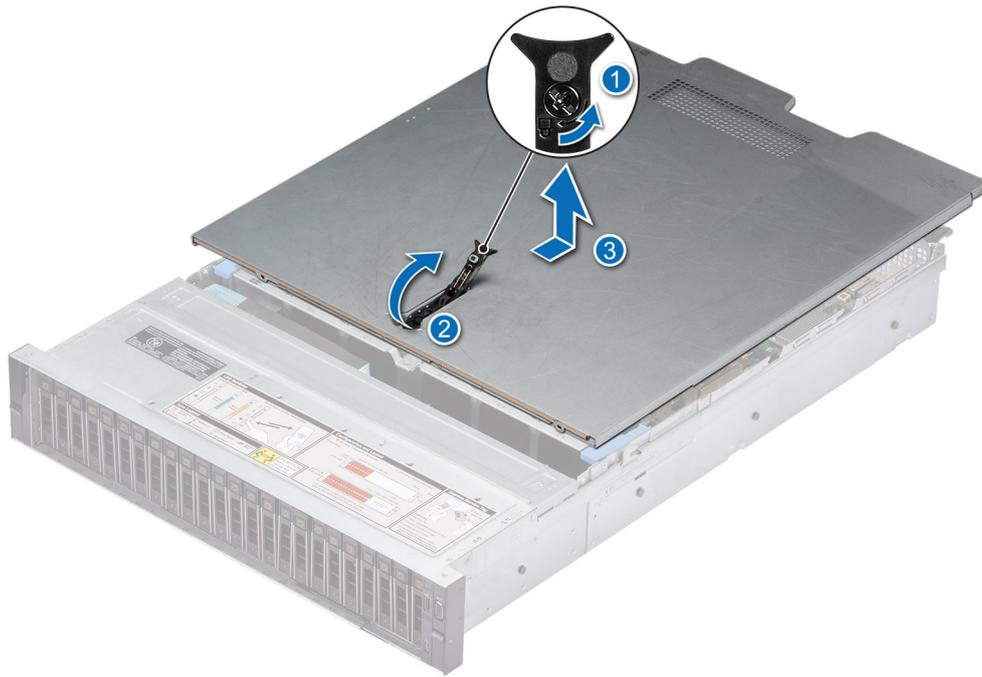
**Ilustración 19. Extracción de la cubierta del sistema**
