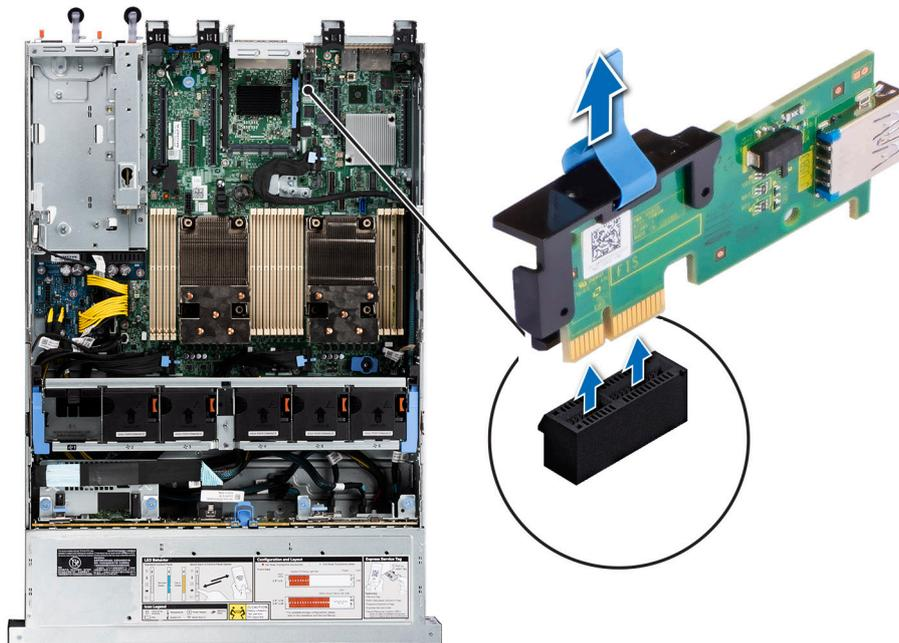
Ilustración 118. Extracción de la tarjeta USB interna
