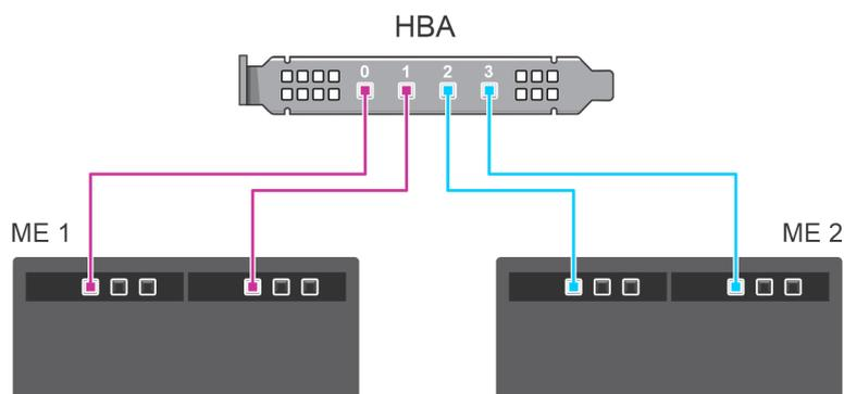
Ilustración 16. Configuración de múltiples rutas: cableado del Adaptador HBA355e con gabinetes ME484
