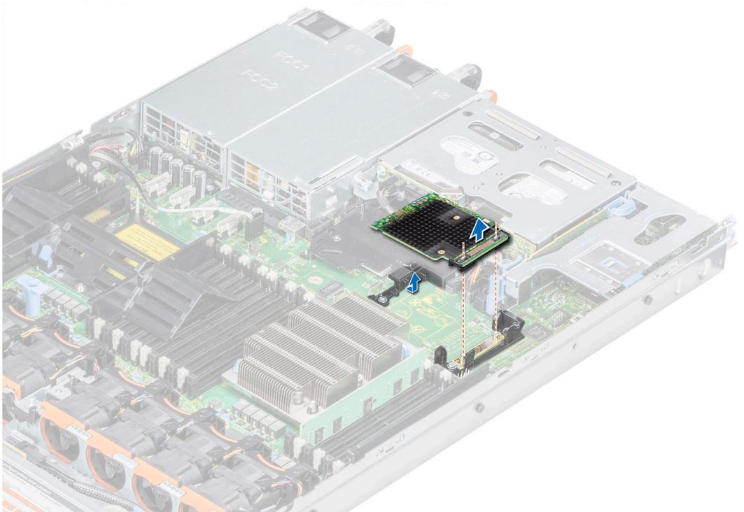
**Ilustración 22. Extracción de HBA350i MM**
