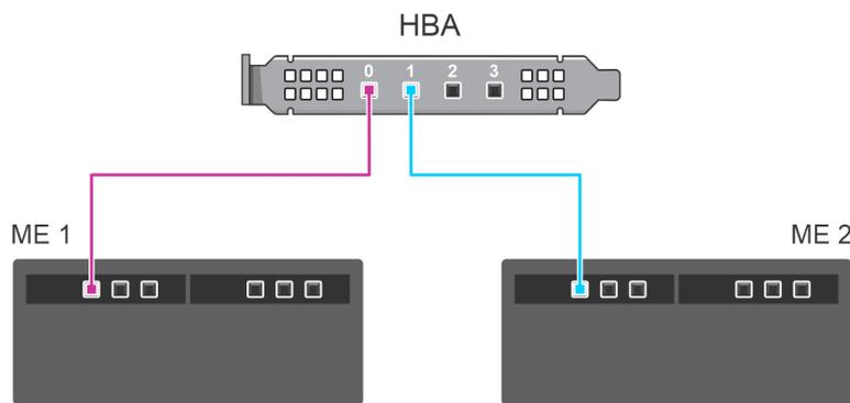
**Ilustración 14. Configuración de ruta única: cableado del Adaptador HBA355e con gabinetes ME484**
