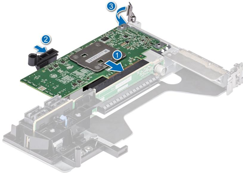
Ilustración 8. Instalar el Adaptador Dell HBA355i
