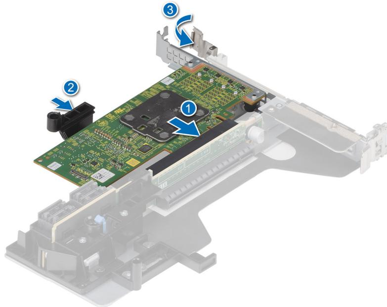
**Ilustración 12. Instale el Adaptador HBA355e**
