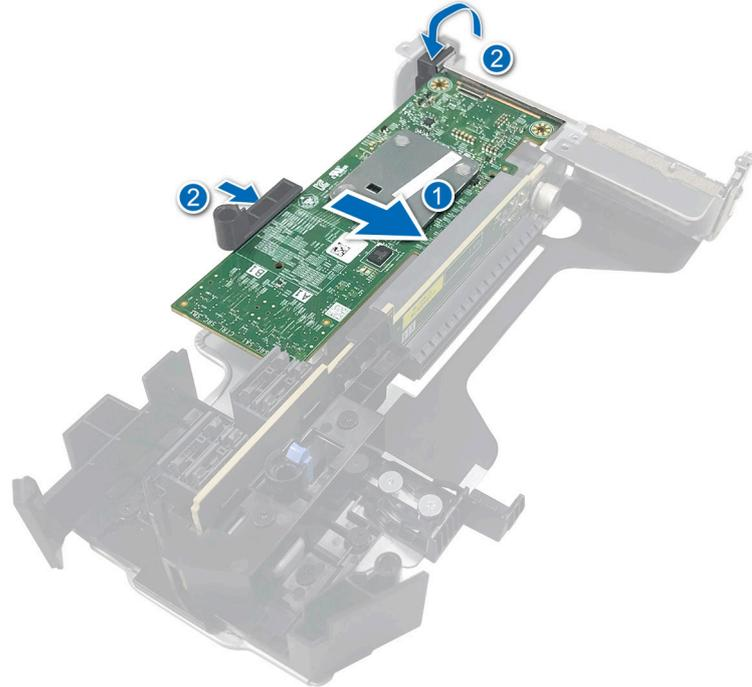
Ilustración 20. Instalar el Adaptador Dell HBA350i
