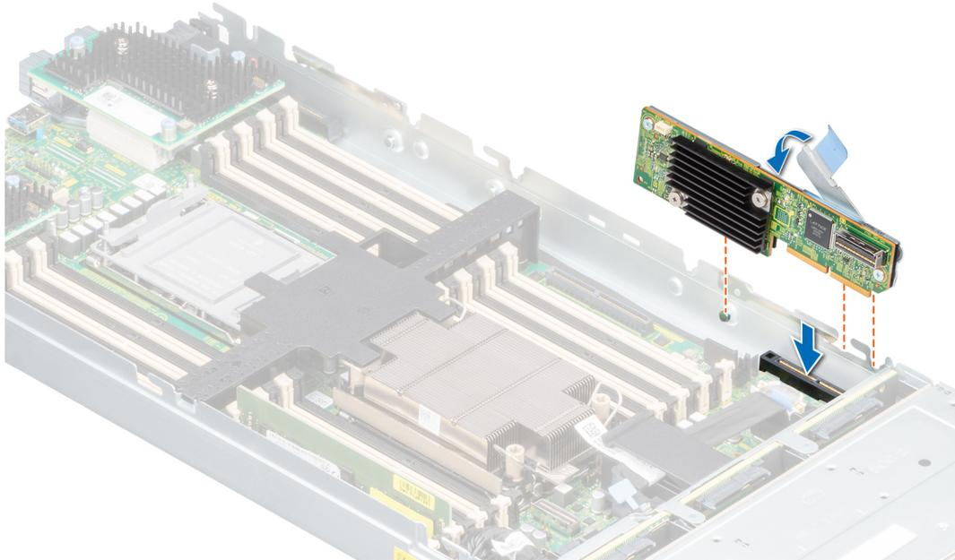
Ilustración 18. Instalar Dell HBA350i MX
