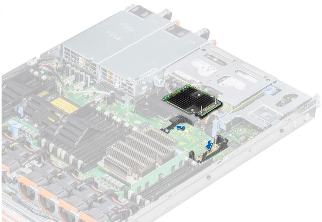
**Ilustración 23. Instalación de Dell HBA350i MM**
