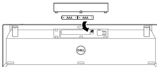
3 Vuelva a colocar la tapa de las pilas.
