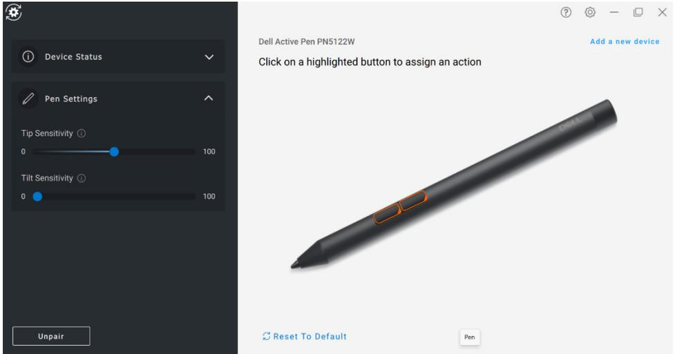
Pour les applications prises en charge telles que Microsoft Whiteboard, les paramètres de sensibilité varient la largeur du brossage en fonction de la pression et de l'angle de la pointe du stylet appliquée à l'écran.
