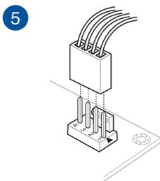
**So installieren Sie einen CPU-Kühlkörper und Lüfter (Typ 2)**
