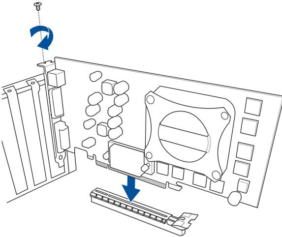
So installieren Sie eine PCIe x4 Karte
