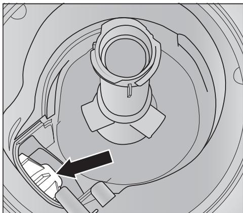
Sotto la copertura si trova la pompa di scarico (freccia).
