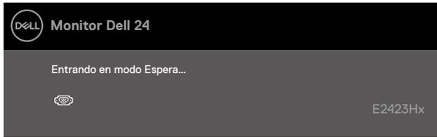
Si el cable VGA, DP o HDMI no está conectado, aparecerá un cuadro de diálogo flotante. El monitor entrará en el modo de espera después de 4 minutos si permanece en este estado.
