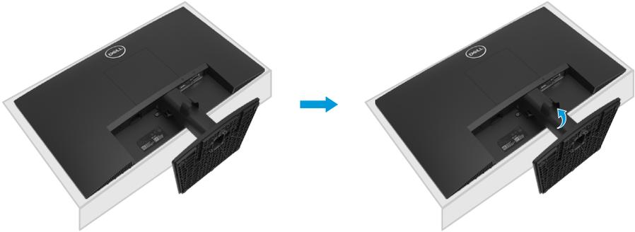
2. a. Utilice un destornillador largo para empujar el seguro de liberación situado en un orificio justo encima de la base.
