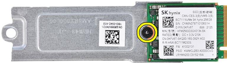
2. Bringen Sie die Schraube (M2x2) zur Befestigung des M.2-2230-Solid-State-Laufwerks an der Halterung für das M.2-2230-Solid-State-Laufwerk wieder an.
