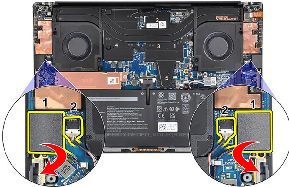
Trennen Sie das linke Lüfterkabel von der Systemplatine.
