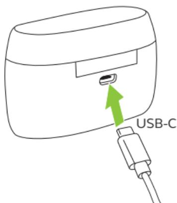
Ti consigliamo di utilizzare un alimentatore da 5 V  $\pm$  0,25 V e una corrente massima di carica inferiore ai 2 A, non ti consigliamo invece di caricare gli auricolari o la custodia usando un caricabatterie da parete con una tensione maggiore.
