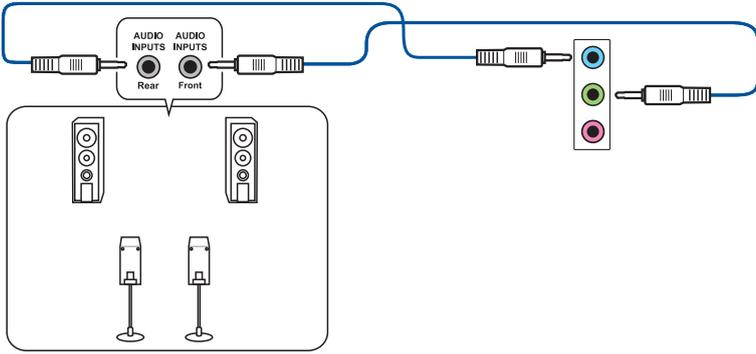
**Conexión de un sistema de altavoces de 5.1 canales**
