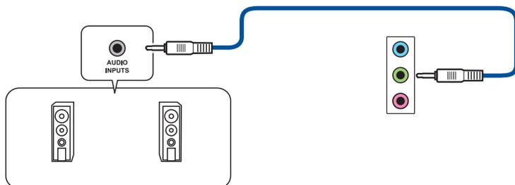
**Conexión de un sistema de altavoces de 4 canales**
