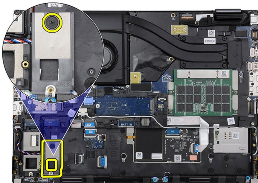
**Figura 1. Rimuovere la cornice dell'SSD dallo slot 4.**
