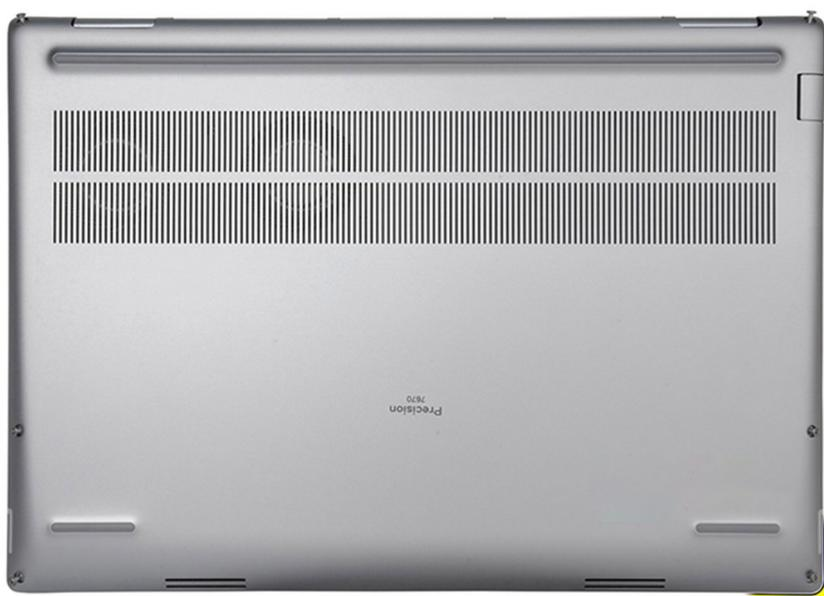
**N.B.:** Per i modelli forniti con lettore di smart card, sollevare il coperchio della base dallo slot del lettore di smart card sul lato inferiore destro del coperchio della base.
