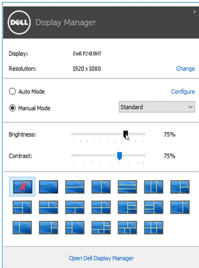
La boîte de dialogue **Réglage rapide** permet également d'accéder à l'interface utilisateur avancée de Dell Display Manager qui est utilisée pour ajuster les fonctions de base, configurer le Mode auto et accéder aux autres fonctions.
