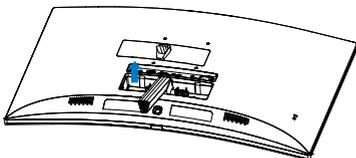
4. Entfernen Sie die Schrauben am Arm mit einem Schraubendreher und lösen Sie den Arm/Ständer vom Monitor.
