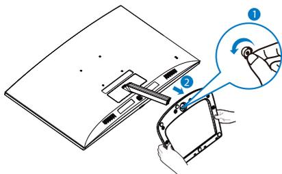
3. Снимите руками крышку шарнира с корпуса монитора.
