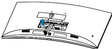
4. Отверткой открутите винты на кронштейне и снимите кронштейн/подставку с монитора.
