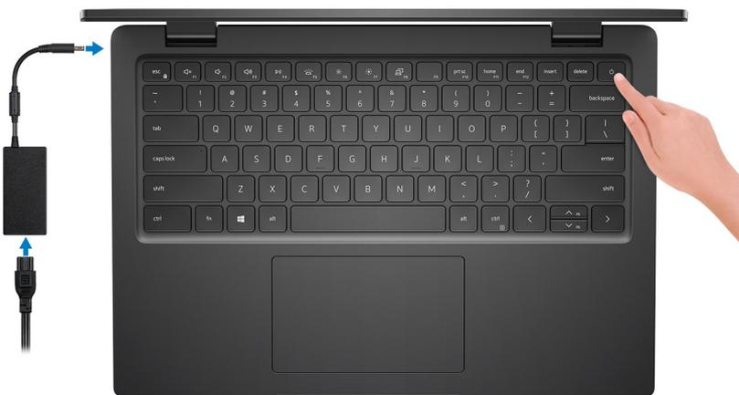
**NOTA:** Para conservar la energía de la batería, es posible que esta ingrese en modo de ahorro energético. Para encender el equipo, conecte el adaptador de alimentación y presione el botón de encendido.
