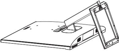
2. Utilisez un tournevis pour desserrer la vis située dans la partie inférieure de la base et retirez la base du support.
