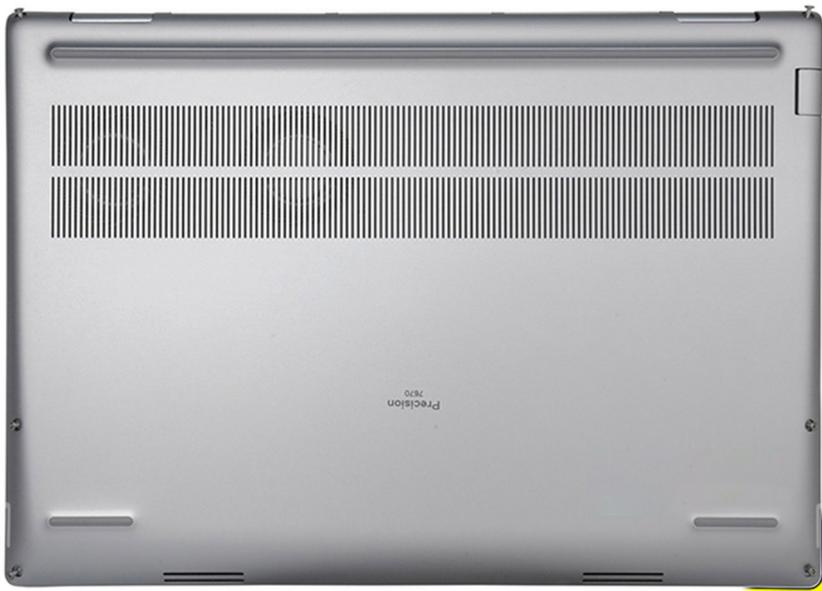
**ANMERKUNG:** Für Modelle, die mit Smartcardlesegerät ausgeliefert werden, hebeln Sie die Bodenabdeckung beginnend von dem Steckplatz für das Smartcardlesegerät an der unteren rechten Seite der Bodenabdeckung auf.
