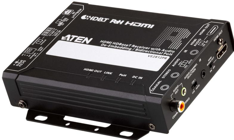
Gracias a la potente tecnología HDBaseT Class A, el receptor VE2812PR es un dispositivo que permite recibir señales de vídeo, audio y control HDMI 4K a una distancia de hasta 100 m a través de un cable de datos Cat. 5e/6/6a o cable Cat. 6 [2L-2910](#) de ATEN. Si se activa el modo de largo alcance HDBaseT, la transmisión de la señal HDMI se puede ampliar hasta una distancia de 150 m a 1080p.
