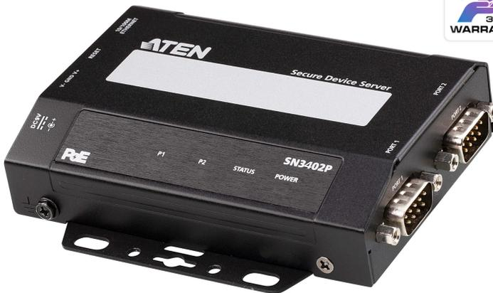
Los servidores de dispositivos seguros SN3402P son dispositivos de red externos basados en IP que conectan de forma segura los dispositivos serie RS-232, RS-422 y RS-485 heredados a una red Ethernet. De este modo, se puede acceder a ellos de forma remota desde un ordenador situado en cualquier lugar, lo que permite ampliar el número de puertos serie de cualquier ordenador anfitrión a través de una red.
