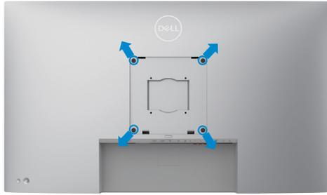
**NOTA:** Utilice tornillos M6 x 35 mm (200 mm x 200 mm) o M4 x 12 mm (100 mm x 100 mm) para acoplar el monitor al kit de instalación en pared.
