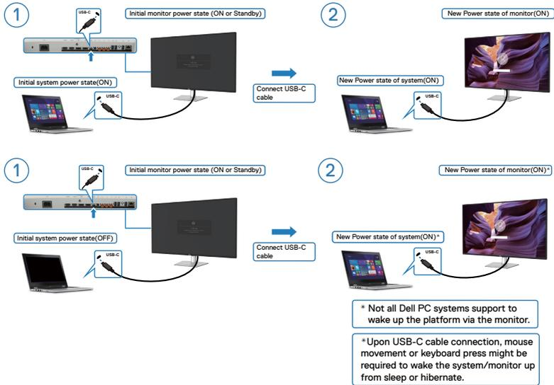
Cuando pulse el botón de alimentación del monitor o el botón de alimentación del PC, el estado del monitor/PC es el siguiente:
