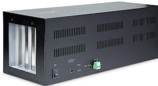
Il robusto chassis di espansione supporta fino a 4 schede aggiuntive PCIe x1 e offre fino a 10 Gbps di larghezza di banda totale. Lo chassis di espansione si collega all'host utilizzando una scheda adattatore USB-C PCIe x2 proprietaria e un cavo USB Type-C bloccabile. Sfrutta funzionalità quali Wake-on-LAN (WoL), supporto per PCI Express Advanced Error Reporting (AER), retro-compatibilità e capacità di alimentazione multipla.
