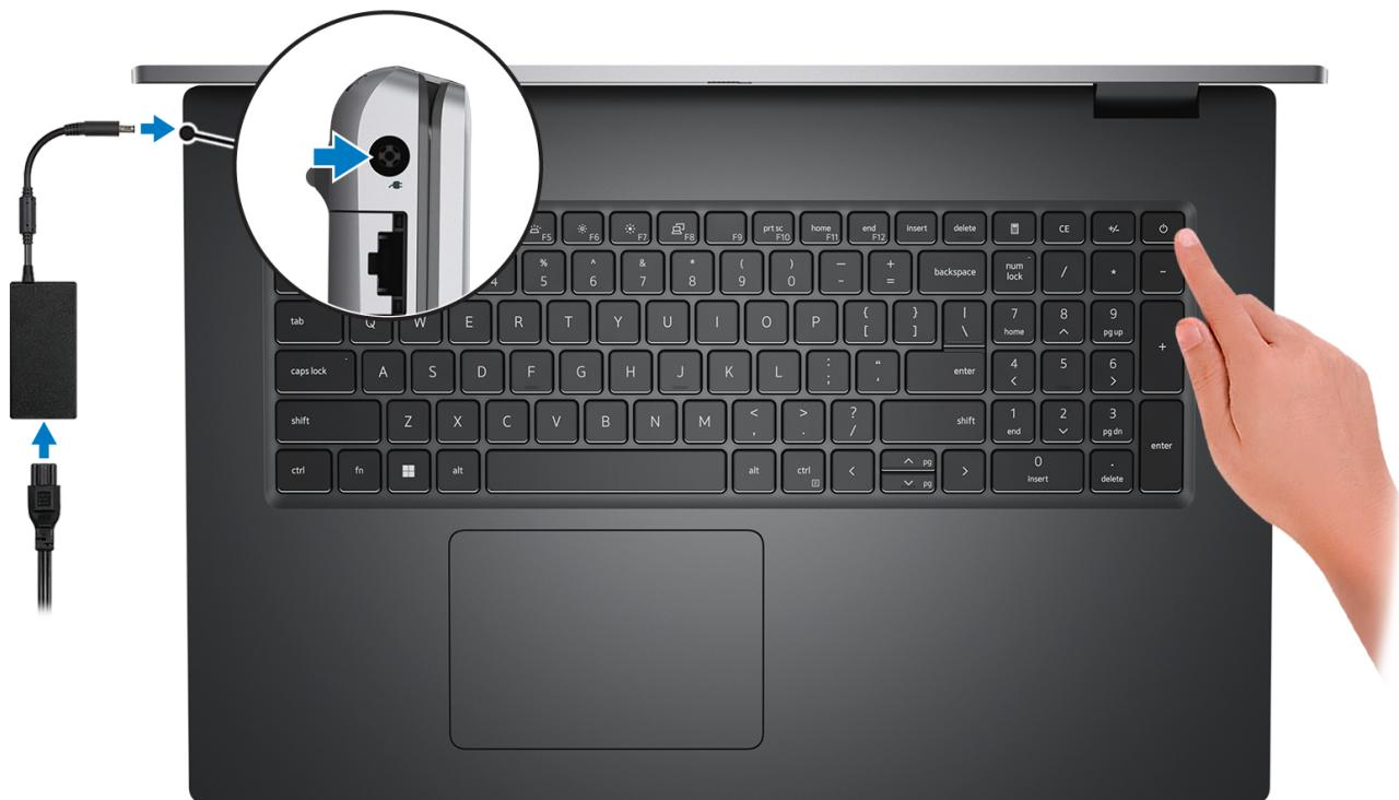
**i OBS:** För att spara på batteriet, kan batteriet gå över i energisparläge. Anslut nätaggregatet och tryck på strömbrytaren så att datorn sätts igång.
