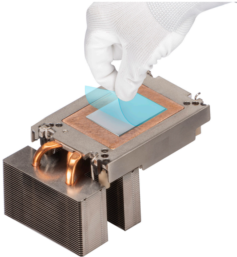
Ilustración 63. Extraiga la película de protección del material de interfaz térmica (TIM)
