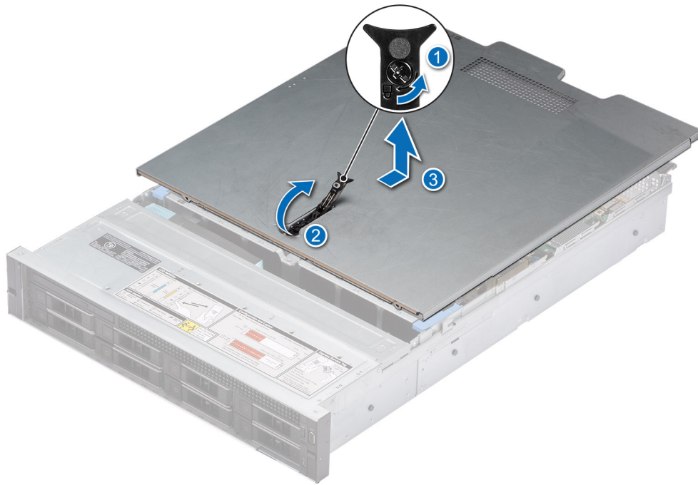
Ilustración 20. Extracción de la cubierta del sistema
