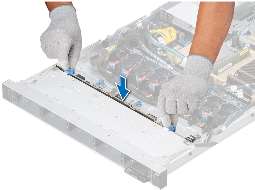
Figure 36. Installation du fond de panier de disque
