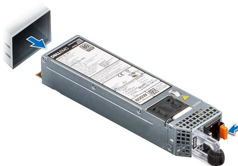
Figure 121. Retrait d'un bloc d'alimentation
