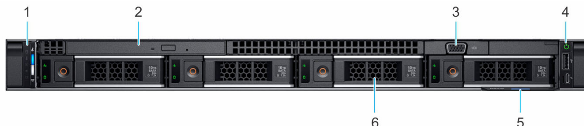
Figure 1. Vue avant d'un système à 4 disques de 3,5 pouces
