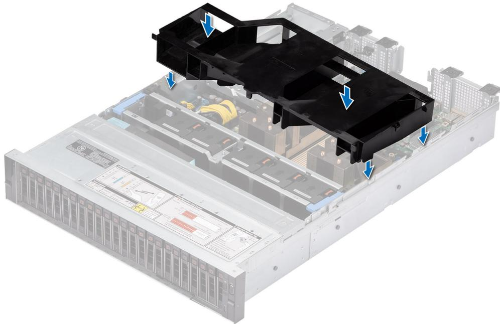
Abbildung 26. Luftstromverkleidung einbauen
