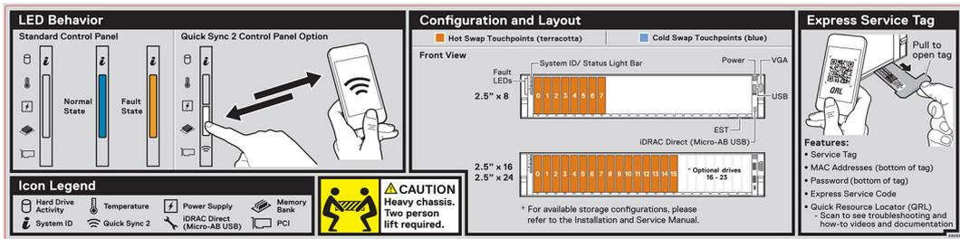
Abbildung 13. LED-Verhalten, Konfiguration und Layout, Express-Service-Tag für 2,5-Zoll-Laufwerkssystem
