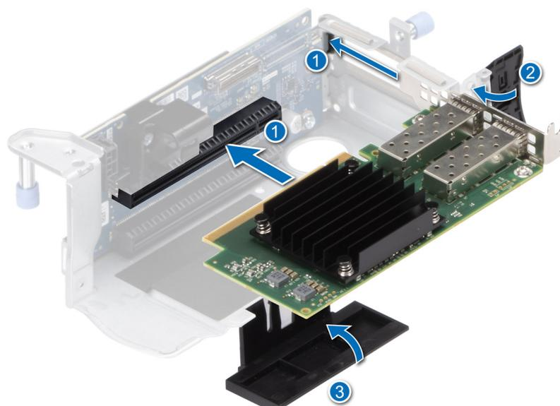
Abbildung 89. Installieren einer Erweiterungskarte in Riser 1B
