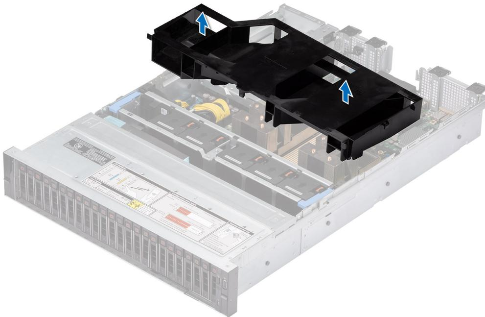
Abbildung 25. Entfernen des Kühlgehäuses
