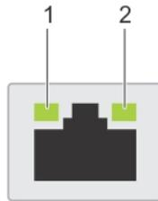
**Abbildung 137. NIC-Anzeigecodes**
