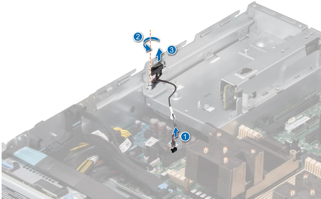
Abbildung 35. Entfernen des Eingriffsschaltermoduls
