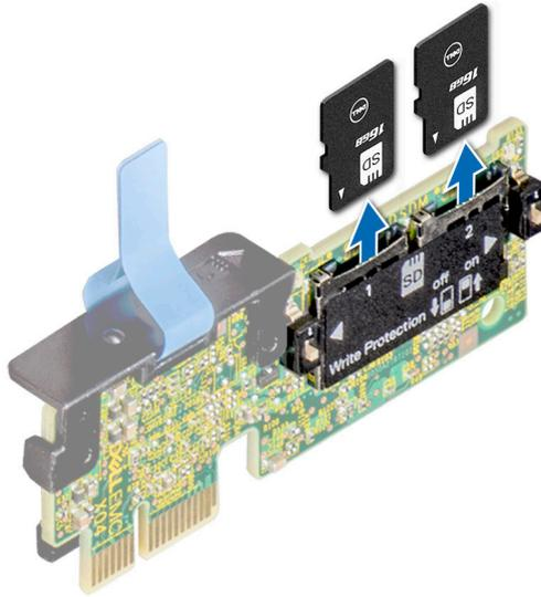
Abbildung 92. Entfernen der microSD-Karte
