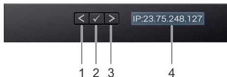
**Abbildung 136. Merkmale des LCD-Display**
