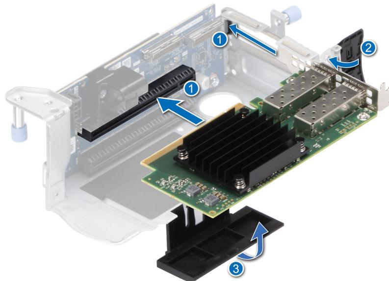
Abbildung 88. Installieren einer Erweiterungskarte in Riser 1A
