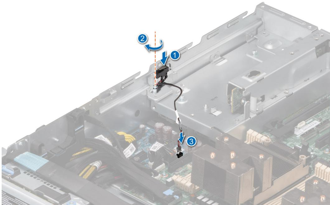
Abbildung 36. Installieren des Eingriffsschalters
