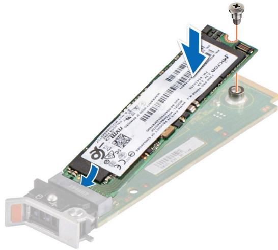
**Abbildung 101. Installieren des M.2-SSD-Laufwerks**
