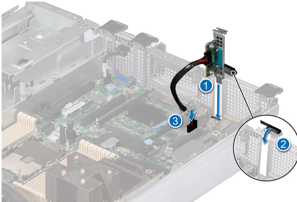
Abbildung 38. Installieren des seriellen COM-Ports
