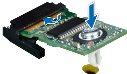
Abbildung 128. Installieren des TPM-Moduls
