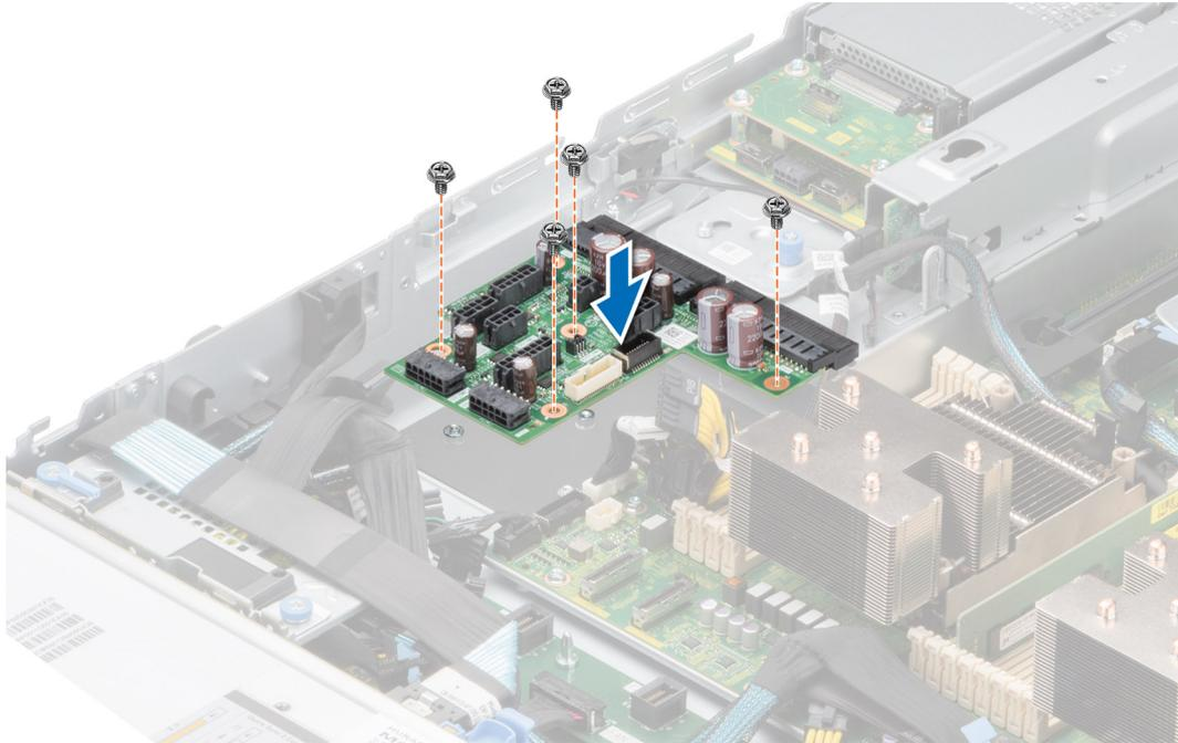
Abbildung 125. Installieren der Stromzwischenplatine
