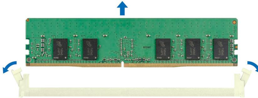
Abbildung 63. Entfernen eines Speichermoduls
