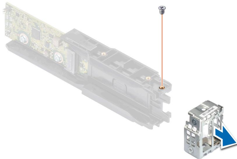
**Abbildung 98. Entfernen des Platzhalters aus der BOSS-S2-Modulabdeckung**
