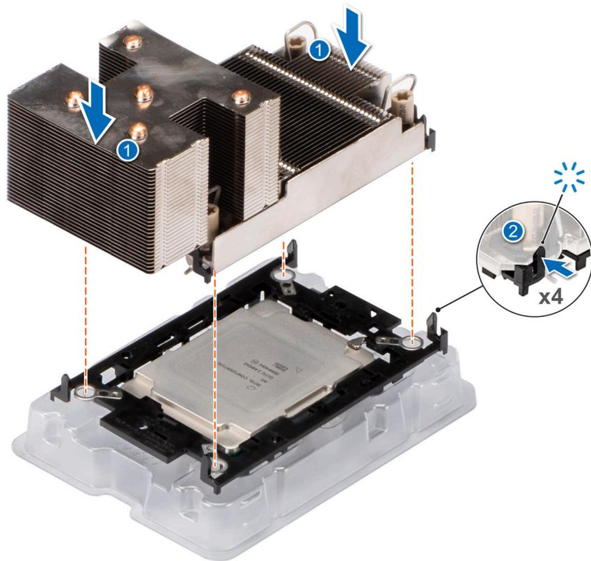
Abbildung 74. Setzen des Kühlkörpers auf den Prozessor ein
