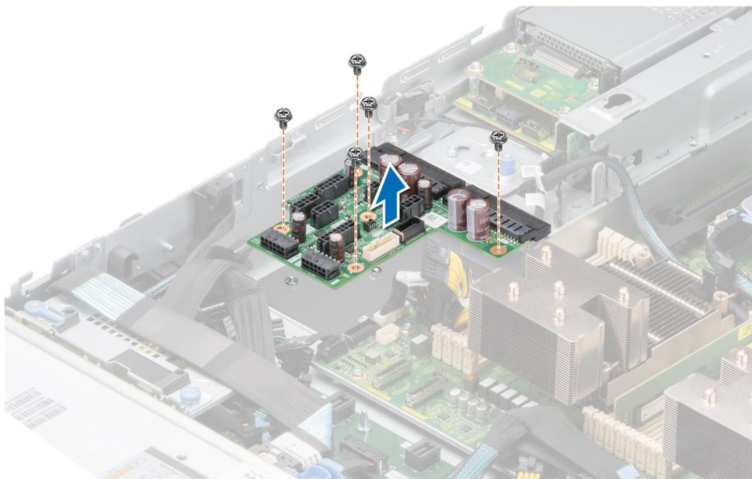
Abbildung 124. Stromzwischenplatine entfernen
