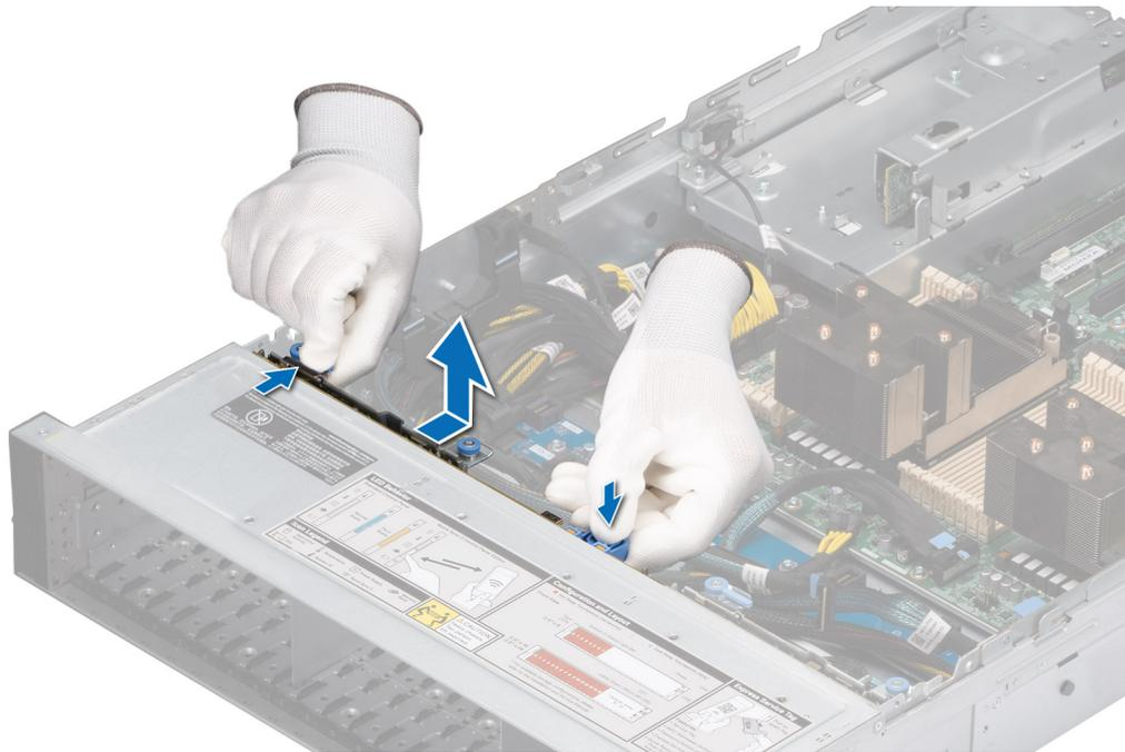
Abbildung 49. Laufwerkrückwandplatte entfernen
