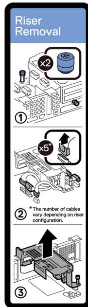
Abbildung 15. Entfernen des Riser
