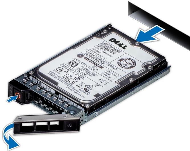
Abbildung 41. Entfernen eines Festplattenträgers
