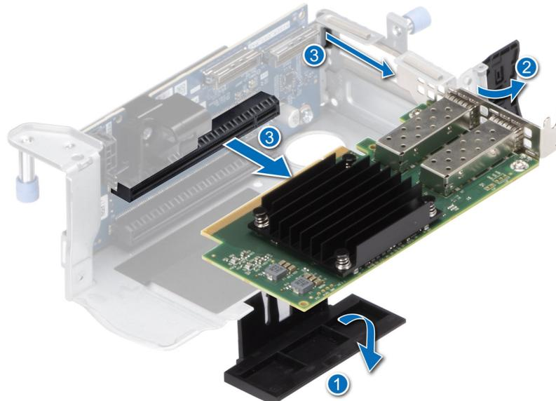
Abbildung 84. Entfernen einer Erweiterungskarte aus Riser 1A
