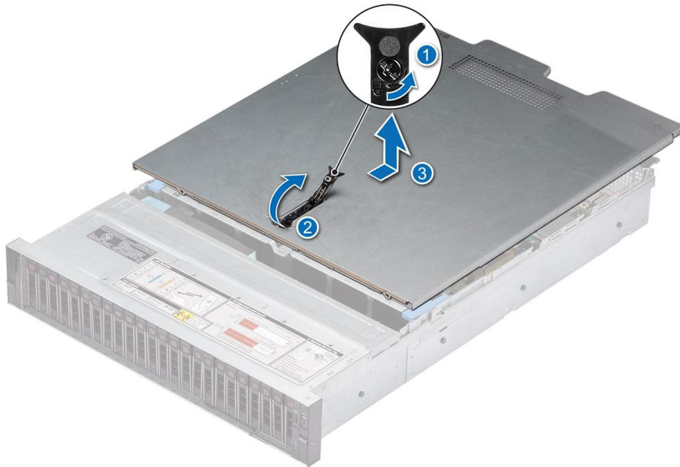
Figure 19. Retrait du capot du système
