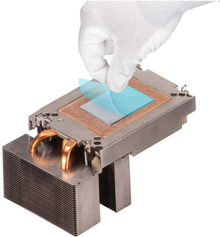
**Figure 73. Retrait du film de protection du matériau d'interface thermique (TIM)**
