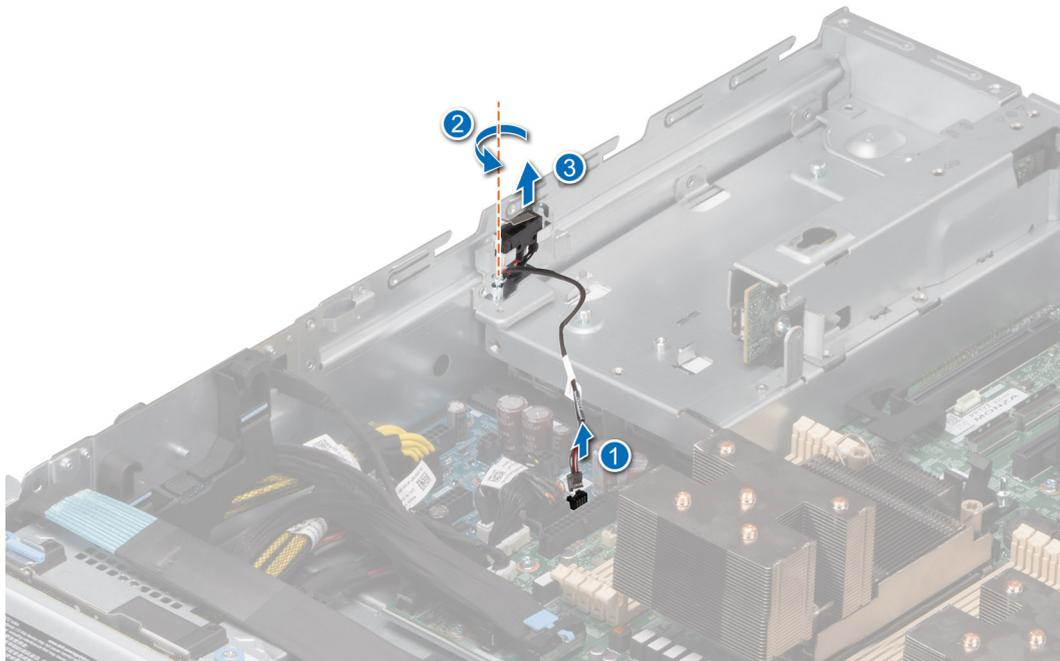
Figure 35. Retrait du module du commutateur d'intrusion
