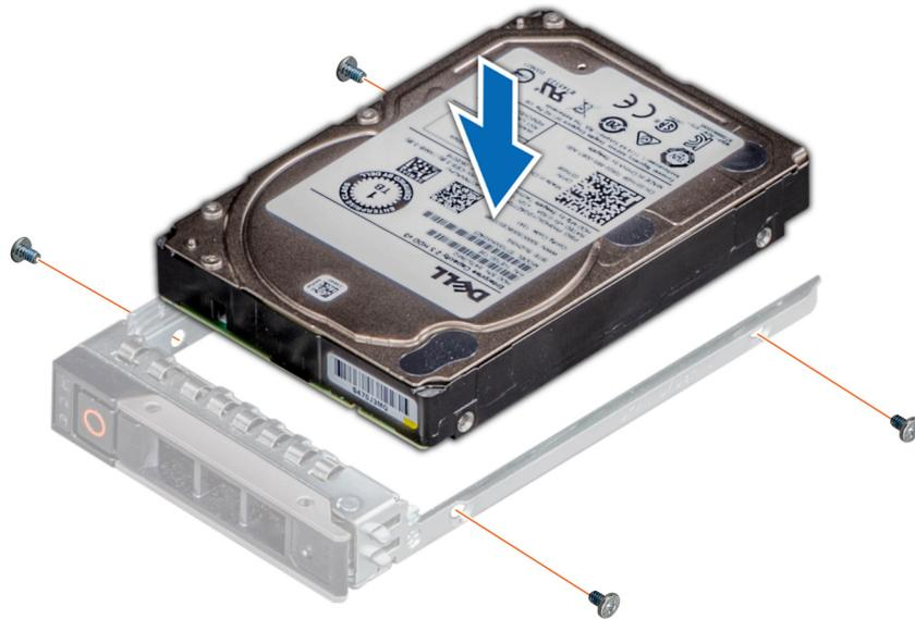
Figure 44. Installation d'un disque dans un support de disque
