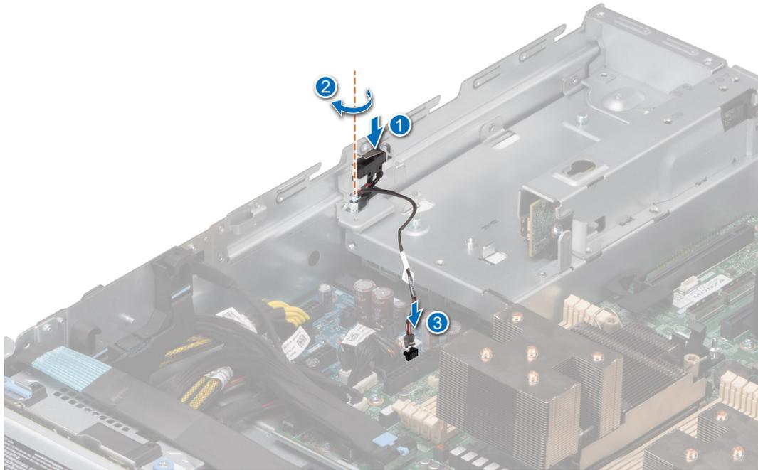
Figure 36. Installation du commutateur d'intrusion
