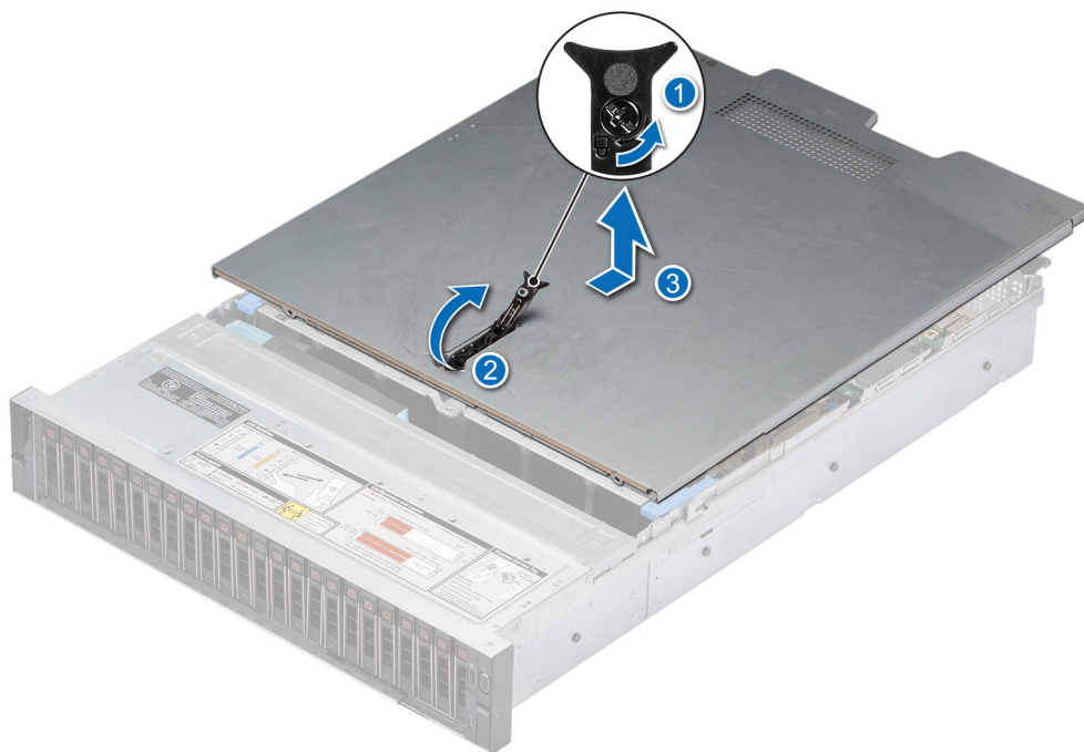
Figure 19. Retrait du capot du système
