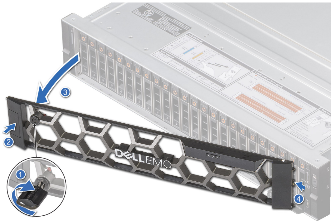
Abbildung 17. Entfernen der Frontblende mit LCD-Display
