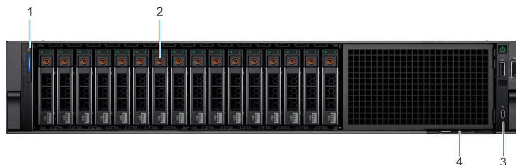
Abbildung 3. Vorderansicht eines Systems mit 16 x 2,5-Zoll-SAS/SATA-Laufwerken
