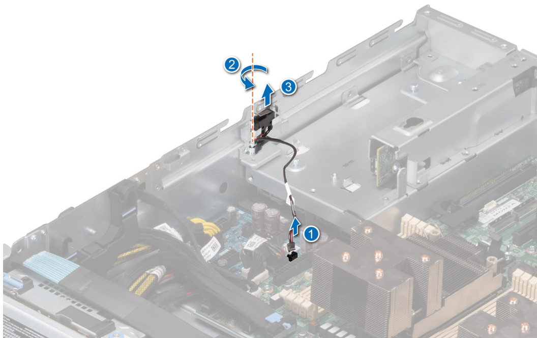
Abbildung 35. Entfernen des Eingriffsschaltermoduls
