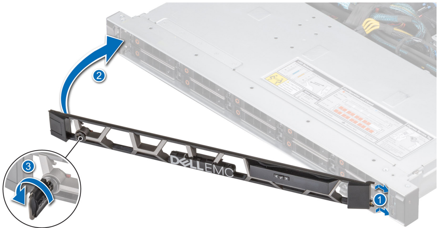
Ilustración 13. Instalación del bisel frontal con el panel LCD
