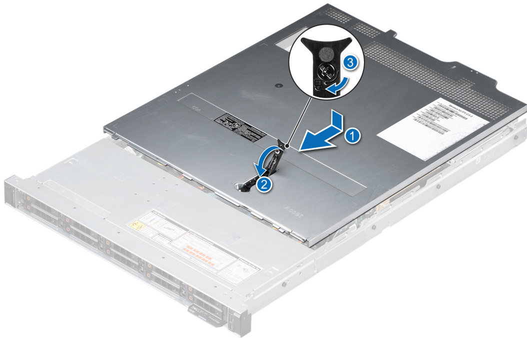
Ilustración 15. Instalación de la cubierta del sistema
