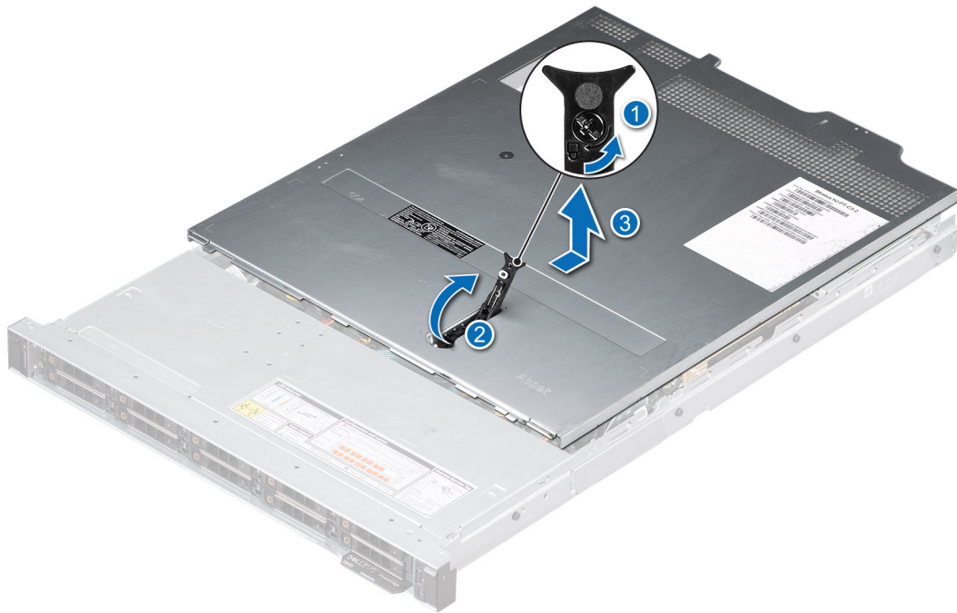
Ilustración 14. Extracción de la cubierta del sistema
