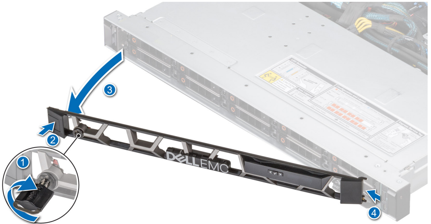
Ilustración 12. Extracción del bisel frontal con el panel LCD
