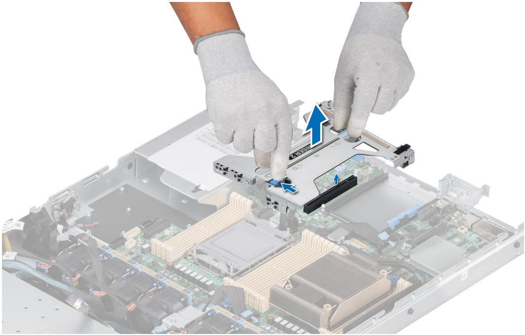
Ilustración 70. Extracción del Soporte vertical 2a
