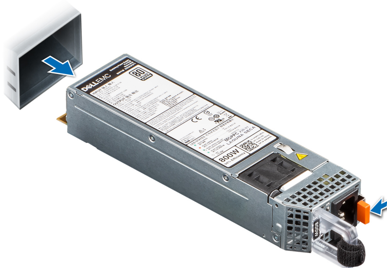
Ilustración 121. Extracción de una fuente de alimentación
