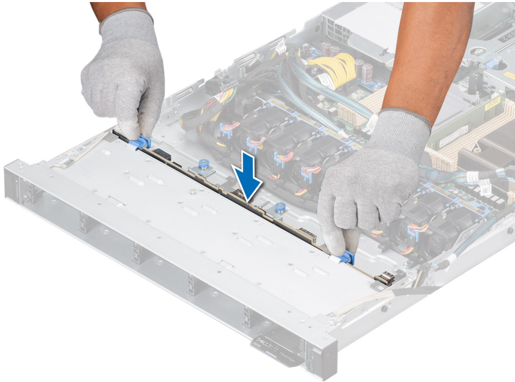
Ilustración 36. Instalación del backplane de la unidad
