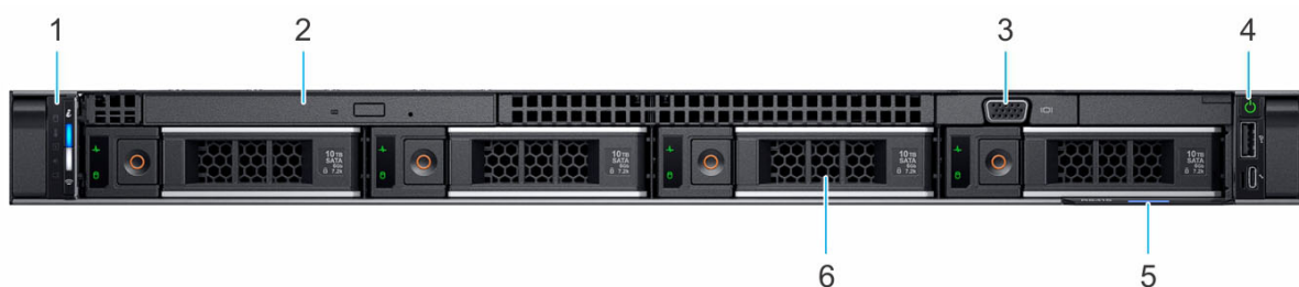
Ilustración 1. Vista frontal de un sistema de 4 unidades de 3,5 pulgadas
