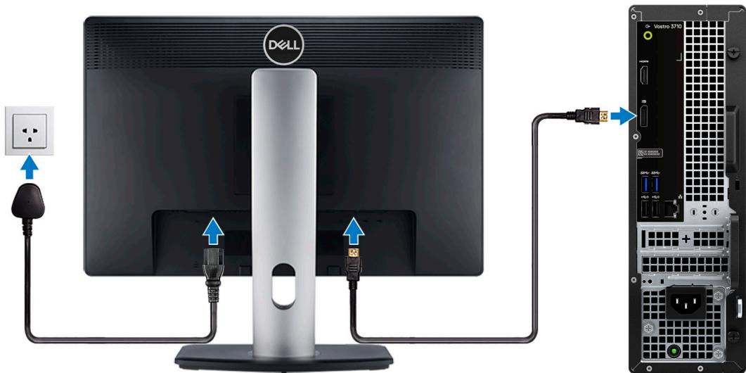
**NOTA:** O local para conectar o cabo de vídeo poderá variar se o computador tiver uma placa gráfica dedicada instalada. Para obter o desempenho ideal da placa gráfica, certifique-se de conectar o cabo de vídeo à placa gráfica se houver uma instalada.
