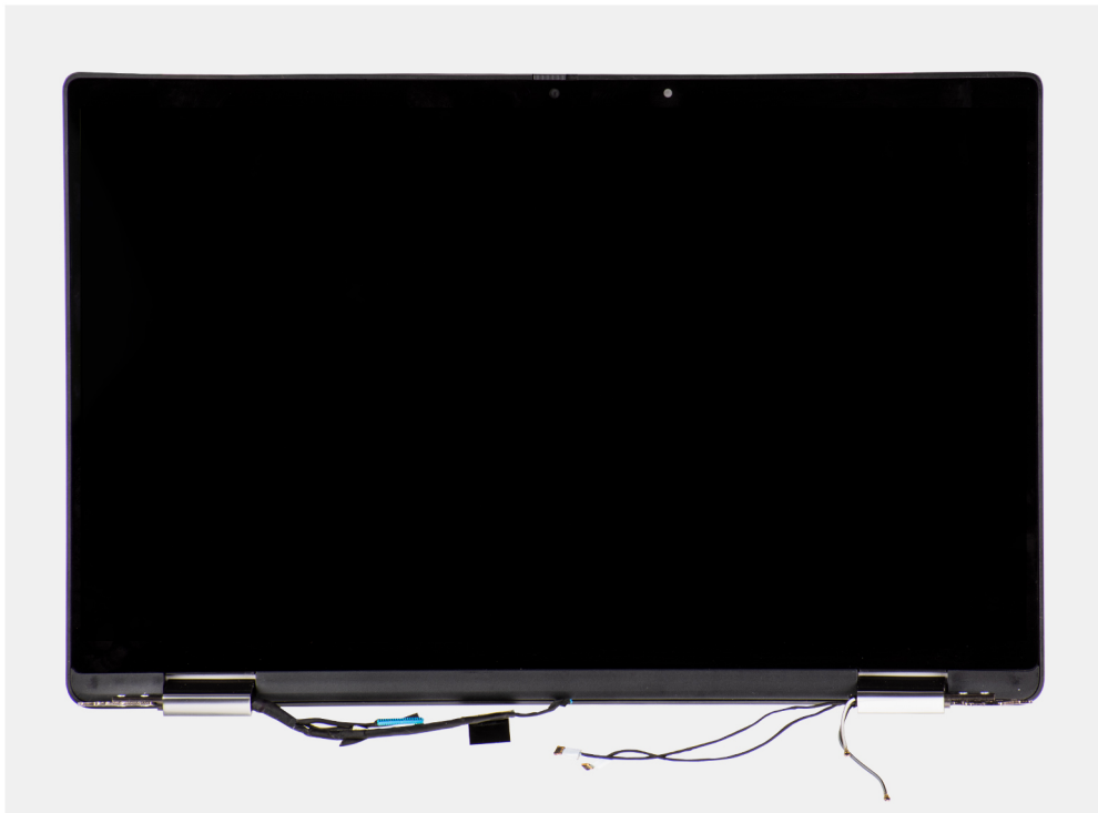
Ilustración 1. Ensamblaje de la pantalla con cables de la antena
