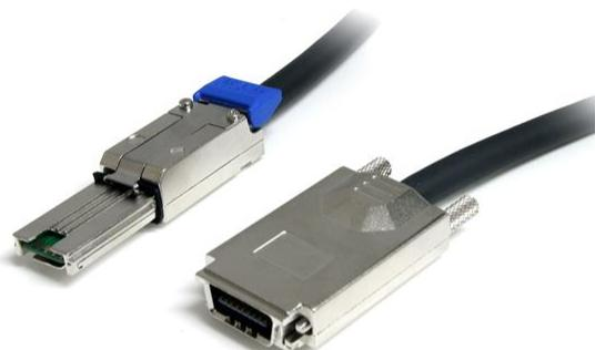
El Cable Serial Attached SCSI de 2 metros, ISAS88702 está diseñado para usar con redes, servidores, estaciones de trabajo y ordenadores de escritorio de alto rendimiento. Este cable SAS dispone de un conector SFF-8470 (Infiniband®) y un conector SFF-8088 (mini-SAS externo), y brinda soporte para velocidades de transferencia de datos de hasta 6 Gbps.
