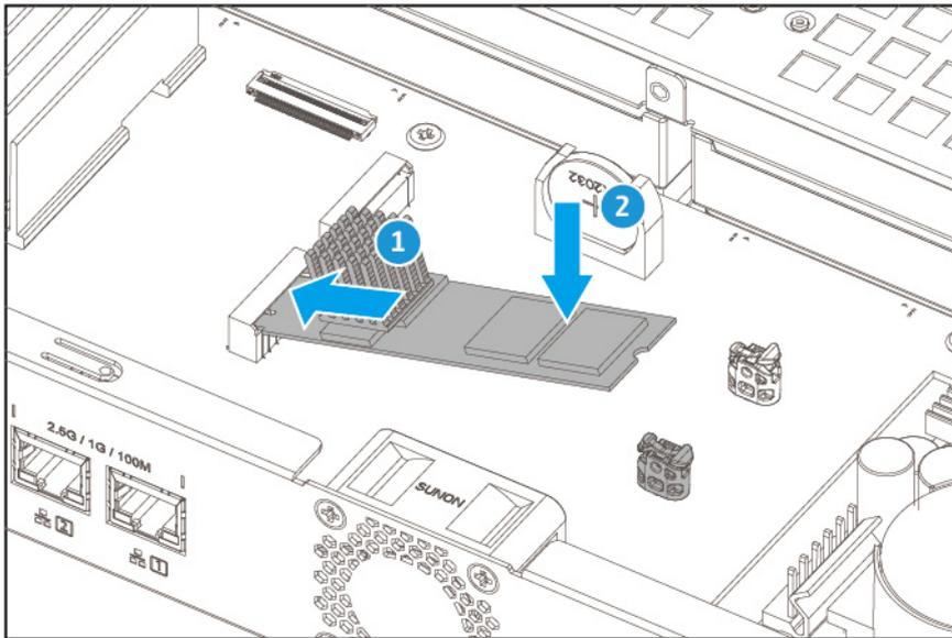
c. Enfoncez doucement le SSD M.2 jusqu'à ce que la punaise verrouille le disque en place.
