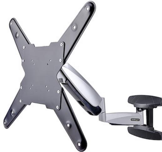
La construcción de acero y aluminio de este soporte de pared para TV VESA admite televisores de 23" a 55" y de hasta 30kg. El conjunto del brazo proporciona un suave ajuste de la altura con un solo toque gracias a su mecanismo de resorte que actúa como contrapeso. La placa VESA admite patrones de montaje de 75x75 a 400x400.
