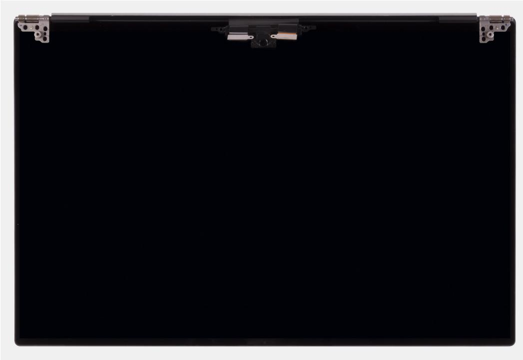
**NOTA:** O conjunto do ecrã tem uma montagem de Design Hinge-Up (HUD) e não pode ser desmontado depois de ser removido do chassis inferior. Se quaisquer componentes no conjunto do ecrã estiverem avariados e necessitarem de ser substituídos, substitua o conjunto do ecrã completo.
