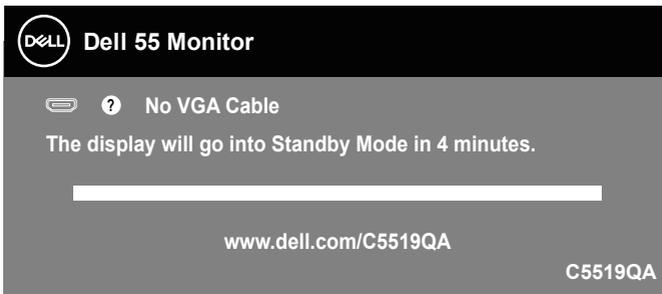
Si le câble HDMI n'est pas branché, une boîte de dialogue flottante, indiquée ci-dessous, apparaît. Le moniteur entrera en Standby Mode (Mode veille) après 4 minutes s'il n'est pas utilisé.
