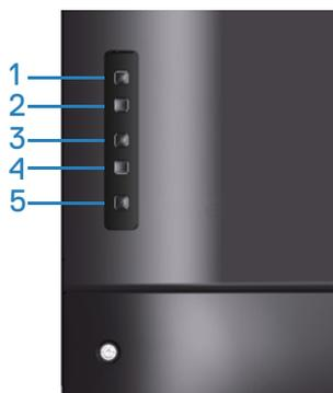
Pour accéder au menu de verrouillage de l'OSD : Maintenez la touche Quitter (bouton 4) enfoncée pendant 4 secondes pour afficher le menu de verrouillage de l'OSD (lorsque l'OSD est déverrouillé). Un menu de verrouillage de l'OSD apparaît et est affiché au centre de l'écran pendant 4 secondes.
