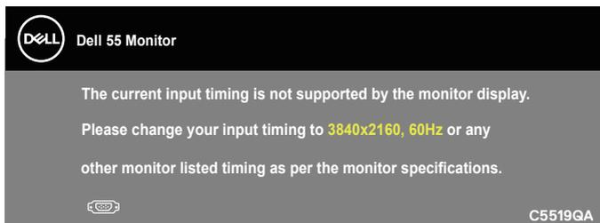
Cela signifie que l'écran ne peut pas se synchroniser avec le signal reçu depuis l'ordinateur. Voir [Spécifications du moniteur](#) pour connaître les limites des fréquences Horizontales et Verticales acceptables par ce moniteur. Le mode recommandé est 3840 X 2160.
