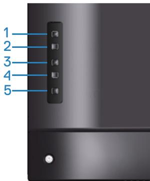
**Activation Ethernet** : Maintenez la touche Haut (bouton 1) enfoncée pendant 4 secondes pour activer Ethernet (lorsque Ethernet est désactivé), une icône réseau
