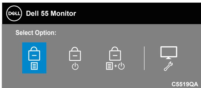
Pour accéder au menu de déverrouillage de l'OSD : Maintenez la touche Quitter (bouton 4) enfoncée pendant 4 secondes pour afficher le menu de verrouillage de l'OSD (lorsque l'OSD est verrouillé). Un menu de déverrouillage de l'OSD apparaît et est affiché au centre de l'écran pendant 4 secondes.
