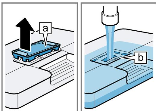
7. Die Abdeckung wieder in die Öffnung am Wassertank einsetzen.
