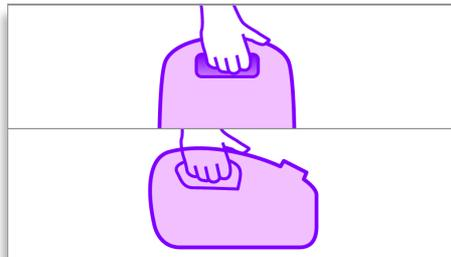
Cet aspirateur est équipé non pas d'une, mais de deux poignées de transport. Lorsqu'il est posé sur ses roues, la poignée située sur le dessus de l'appareil vous permet de déplacer l'aspirateur presque sans vous pencher. La deuxième poignée est placée à l'avant et vous permet de transporter facilement l'aspirateur en position verticale.
