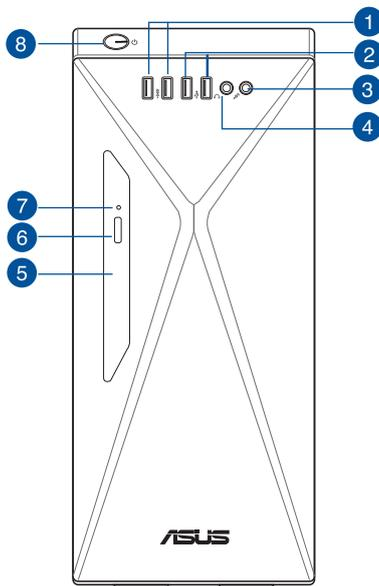
1. **Puertos USB 3.2 Gen 1 o puertos USB 3.2 Gen 1 + USB Type-C®.** Estos puertos USB 3.2 Gen 1 o puertos USB 3.2 Gen 1 + USB Type-C® (opcionales) se conectan a dispositivos USB 3.2 Gen 1 o USB 3.2 Gen 1 + USB Type-C®, como ratones, impresoras, escáneres, cámaras, PDA y otros.
