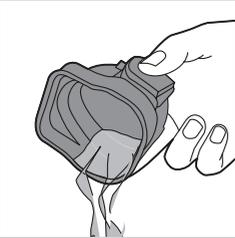
**5** Naplňte čisticí komoru řešením Jet Clean (HQ200) až po značku MAX.
