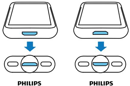
**3** Ajustez les amortisseurs latéraux du connecteur pour stabiliser le téléphone.
