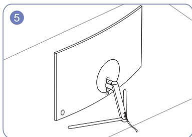
Rangez l'alimentation électrique connectée et le câble de données puis couvrez la PARTIE SECONDAIRE DU CAPOT ARRIÈRE comme le montre l'illustration.
