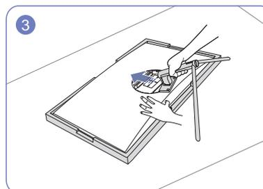
Placez la mousse de polystyrène de protection (coussin) incluse dans l'emballage sur le sol et posez le produit sur la mousse, face orientée vers le bas, comme indiqué sur l'image.
