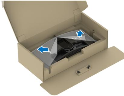
6. Insérez avec précaution les onglets de la colonne du pied dans les fentes du capot arrière de l'écran et abaissez l'ensemble du pied pour l'enclencher en place.
