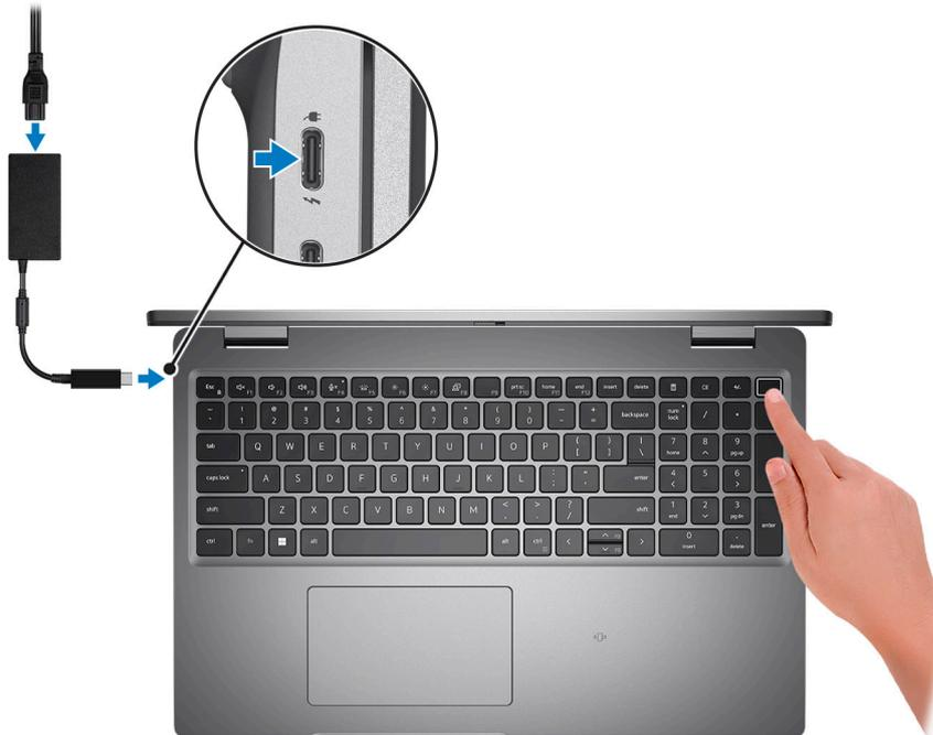
**i** **N.B.:** Per conservare autonomia, la batteria potrebbe entrare in modalità di risparmio di energia. Collegare l'adattatore per l'alimentazione e premere il pulsante di accensione per accendere il computer.
