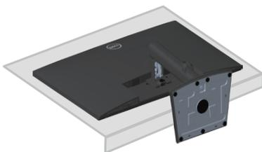
2. Desaperte totalmente o parafuso manual no suporte com inclinação.
