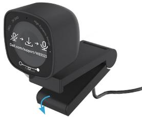
2. Placez la webcam sur le cadre du moniteur et ajustez le pied du clip de montage universel à l'arrière du moniteur jusqu'à ce que la webcam repose fermement sur le cadre du moniteur.
