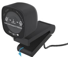
2. Coloque a câmara Web na moldura do monitor e ajuste a base do clipe de montagem universal na traseira do monitor até a câmara Web encaixar firmemente na moldura do monitor.
